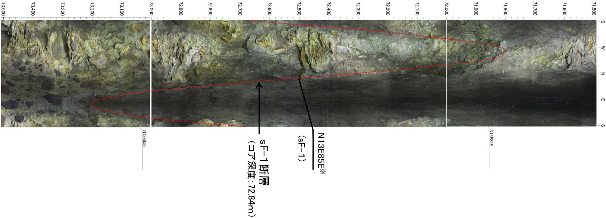
※: ボーリングコアにおける断層深度、性状等を考慮し再検討した結果、BHTV画像の「断層面と孔壁との交線」(赤点線)及び「走向傾斜の解析値」をN18E85EからN13E85Eに見直した。
