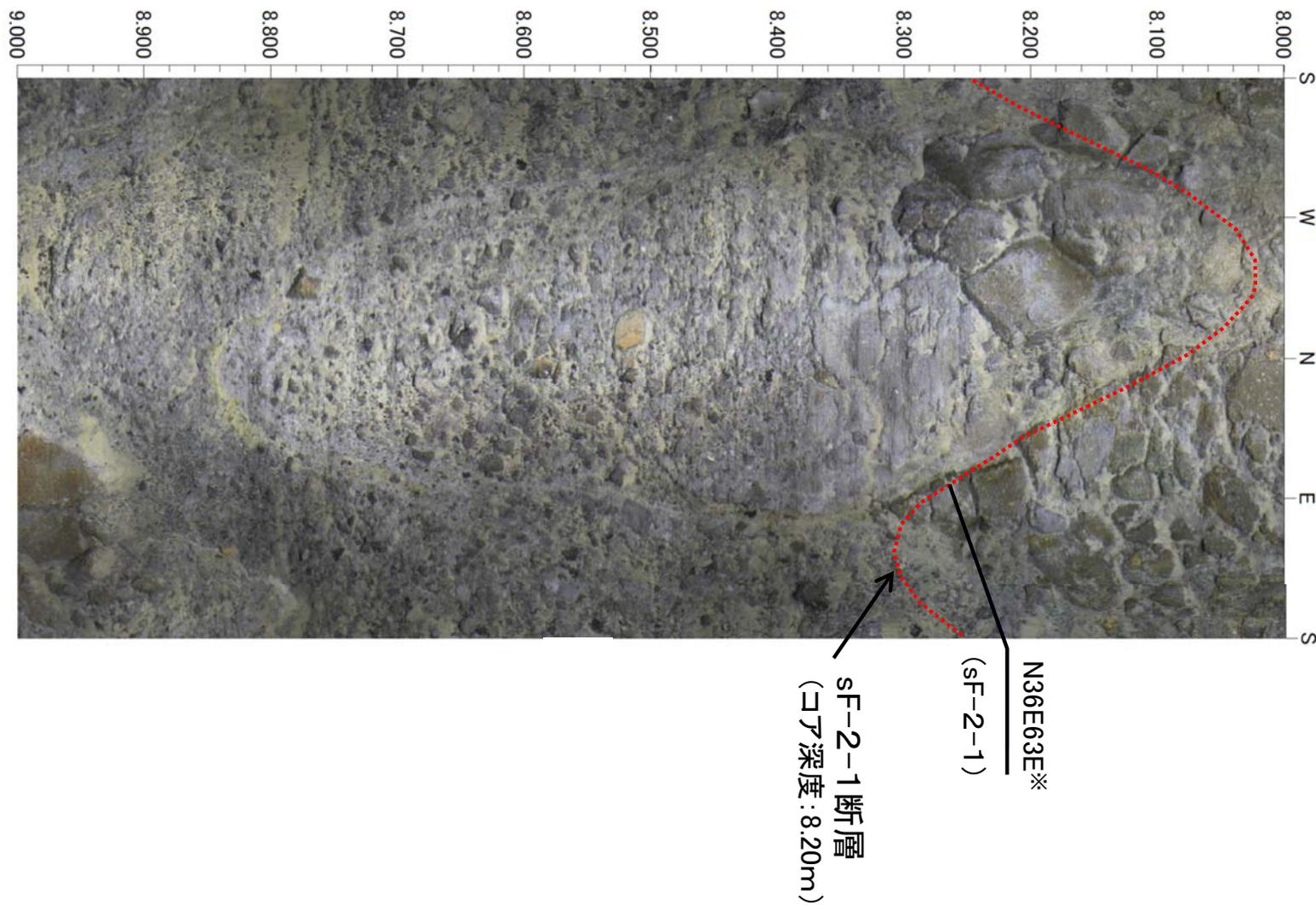
※:ボーリングコアにおける断層深度, 性状等を考慮し再検討した結果, BHTV画像の「断層面と孔壁との交線」(赤点線)及び「走向傾斜の解析値」をN86W76NからN36E63Eに見直した。
