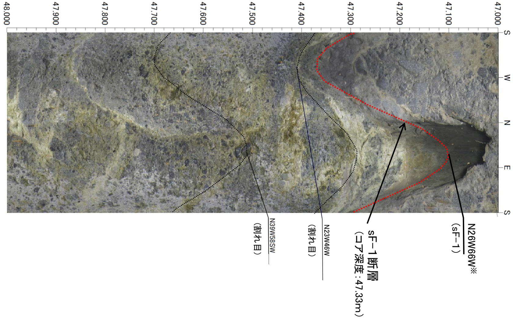
※:ボーリングコアにおける断層深度, 性状等を考慮し再検討した結果, BHTV画像の「断層面と孔壁との交線」(赤点線)及び「走向傾斜の解析値」をN23W46WからN26W66Wに見直した。
