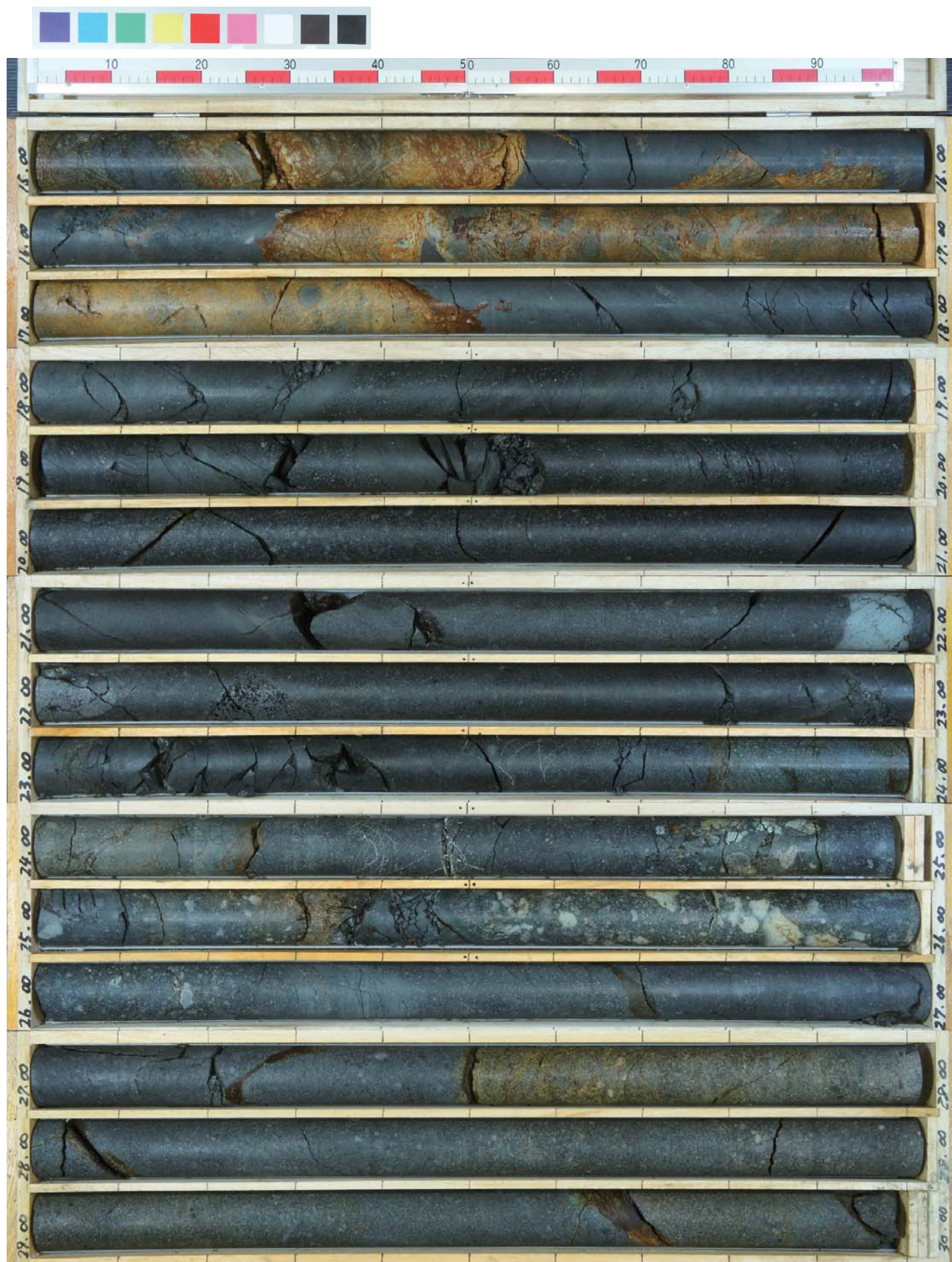
コア写真(確認-1ボーリング:深度15~30m)
