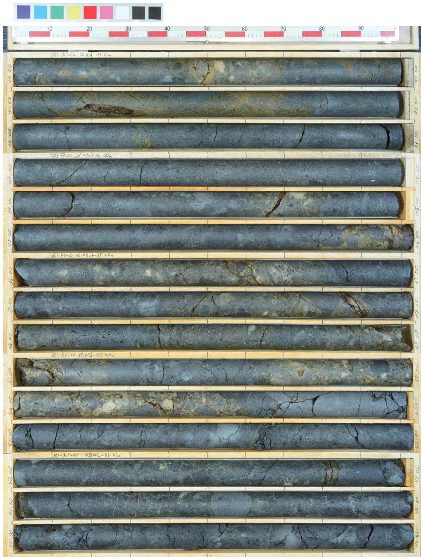
コア写真(確認-2ボーリング:深度30~45m)
