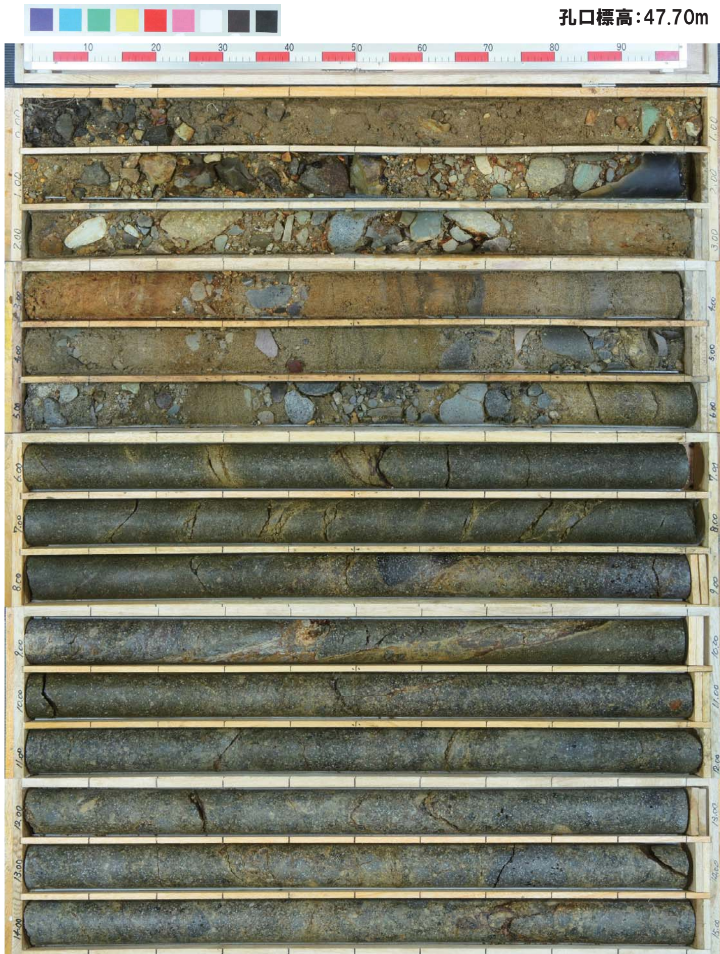
コア写真(確認-3ボーリング:深度0~15m)
