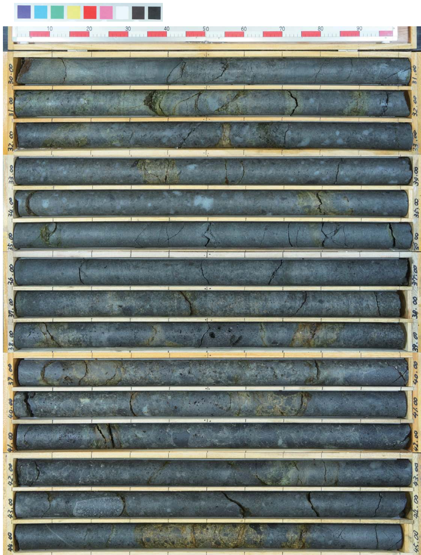
コア写真(確認-1ボーリング:深度30~45m)
