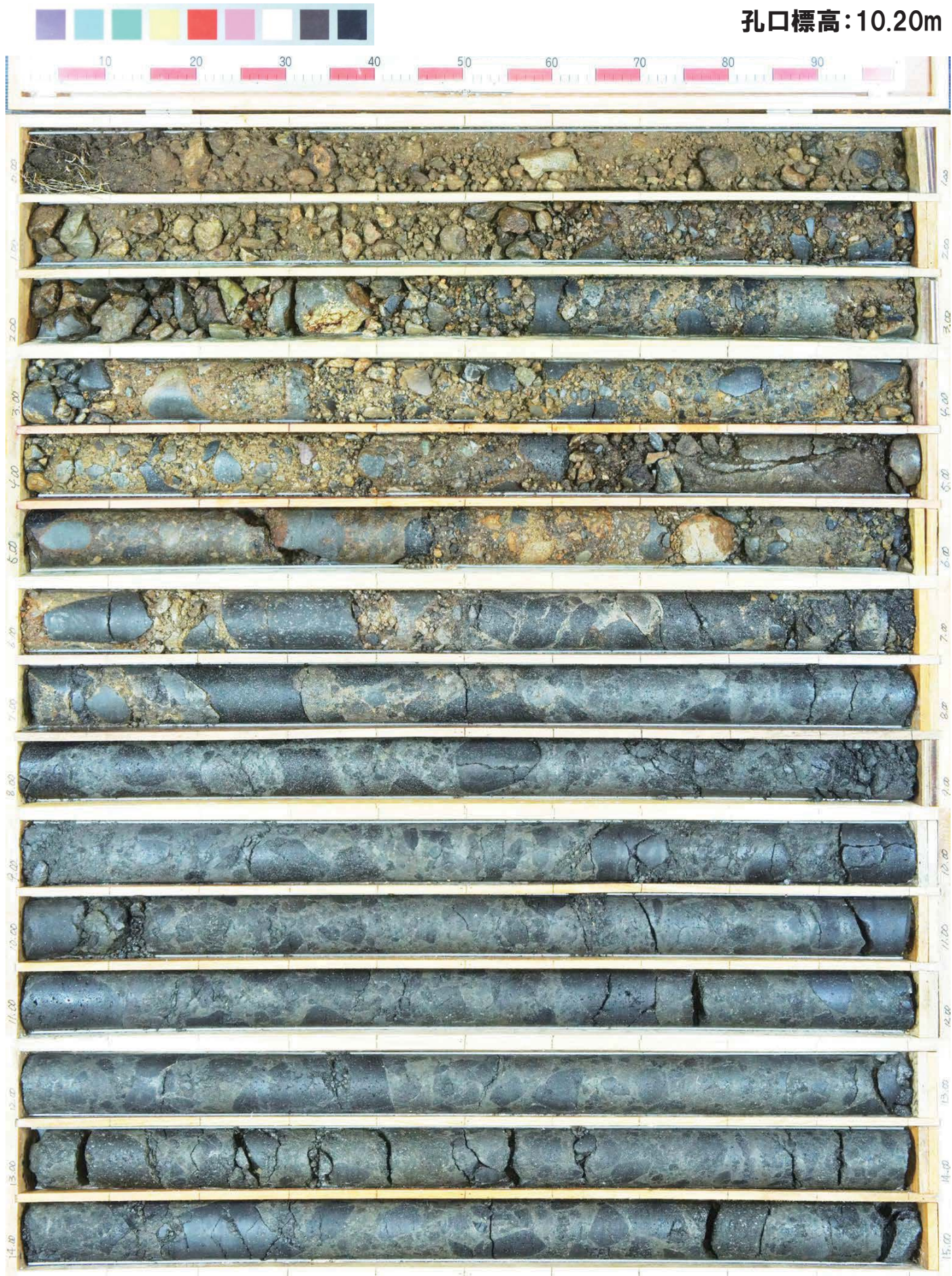
コア写真 (R1敷地-6ボーリング: 深度0~15m)
