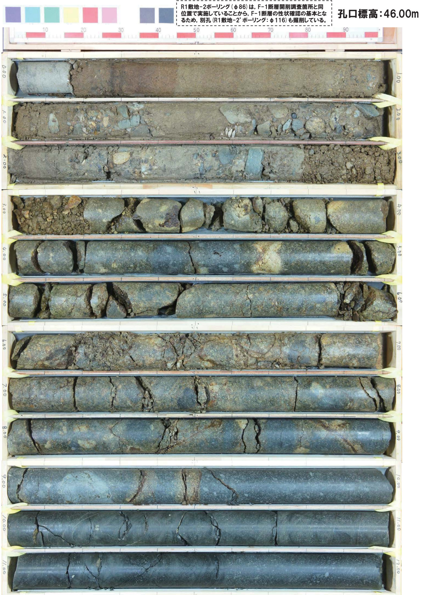
コア写真(R1敷地-2'ボーリング:深度0~12m)
