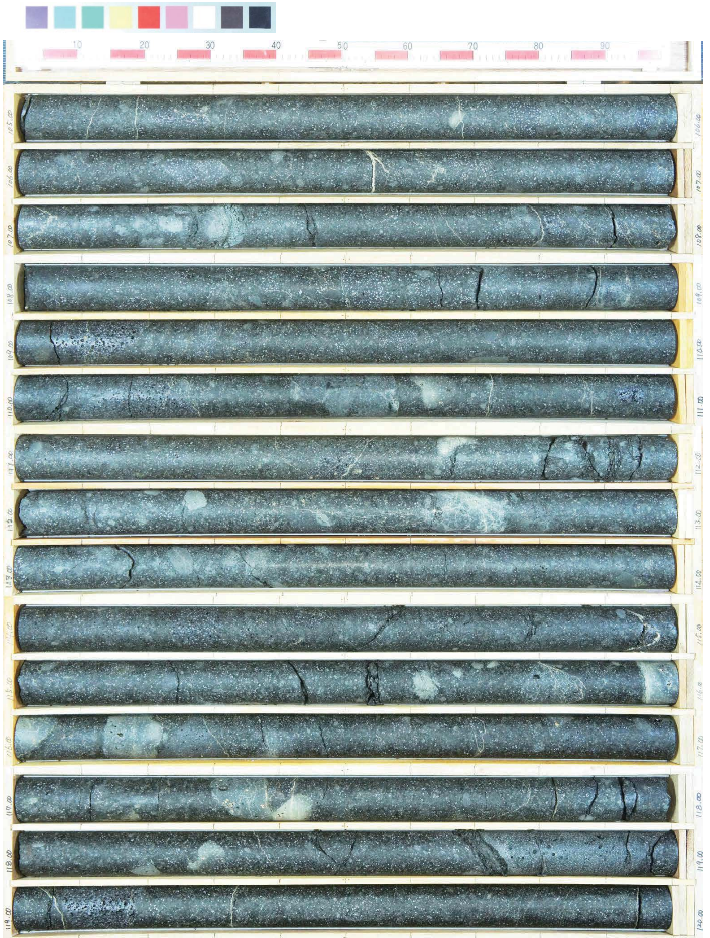
コア写真 (R1敷地-6ボーリング:深度105~120m)
