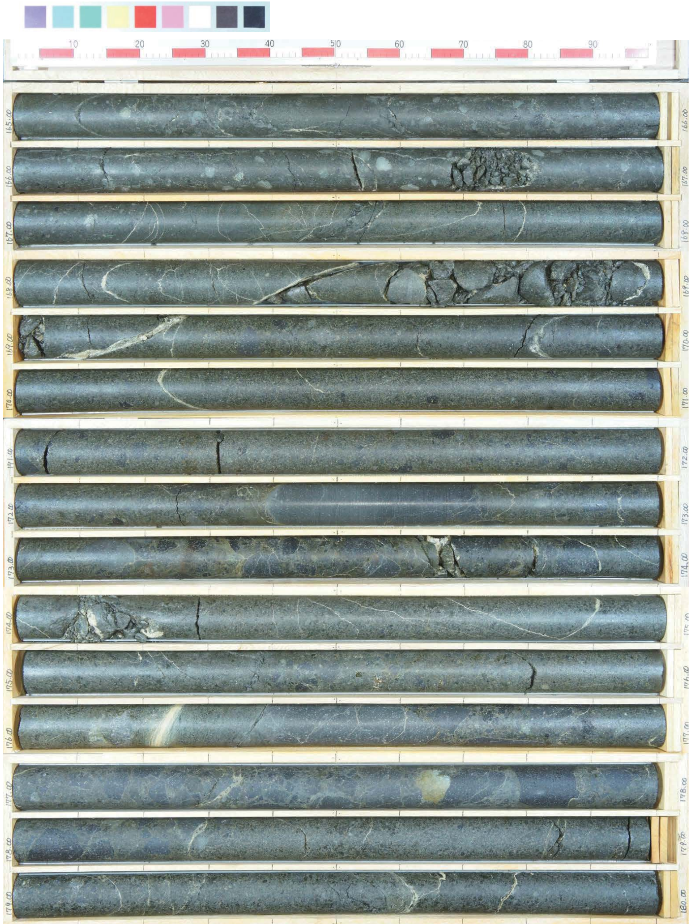
コア写真 (R1敷地-6ボーリング:深度165~180m)
