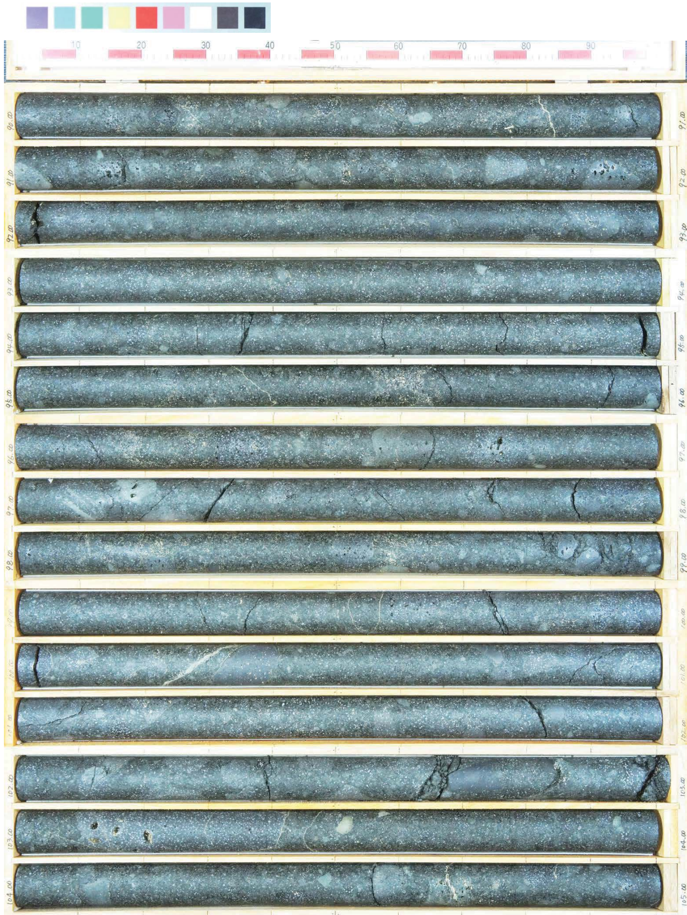
コア写真 (R1敷地-6ボーリング:深度90~105m)
