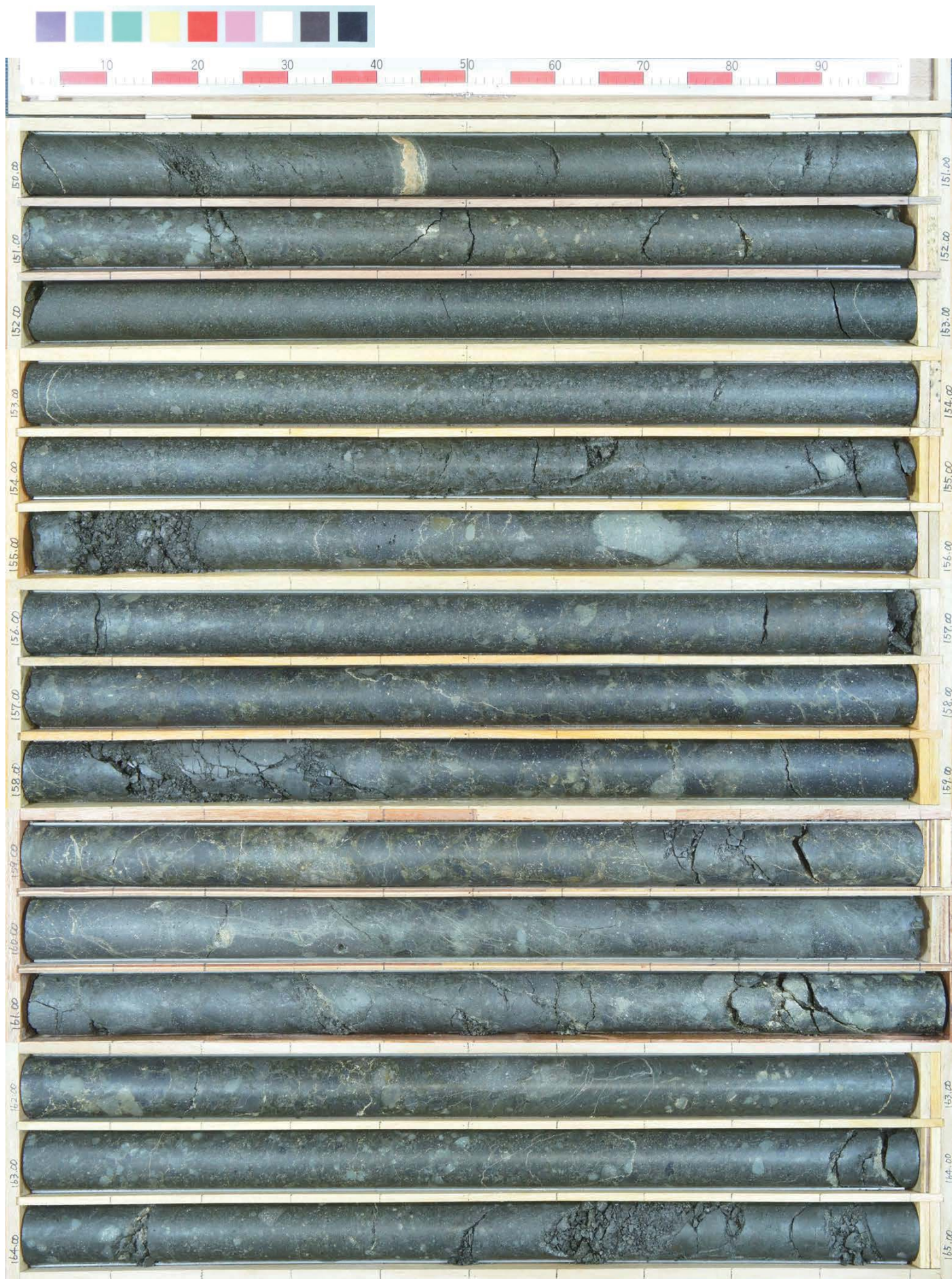
コア写真 (R1敷地-6ボーリング:深度150~165m)
