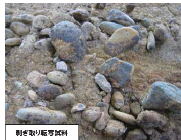
【(仮) Hm3段丘堆積物(礫層)】 ・新鮮な礫を主体とする垂円～円礫 (扁平礫含む)
