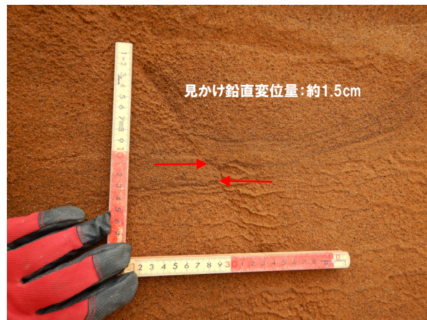
⑦-2 見かけ鉛直変位量測定箇所
