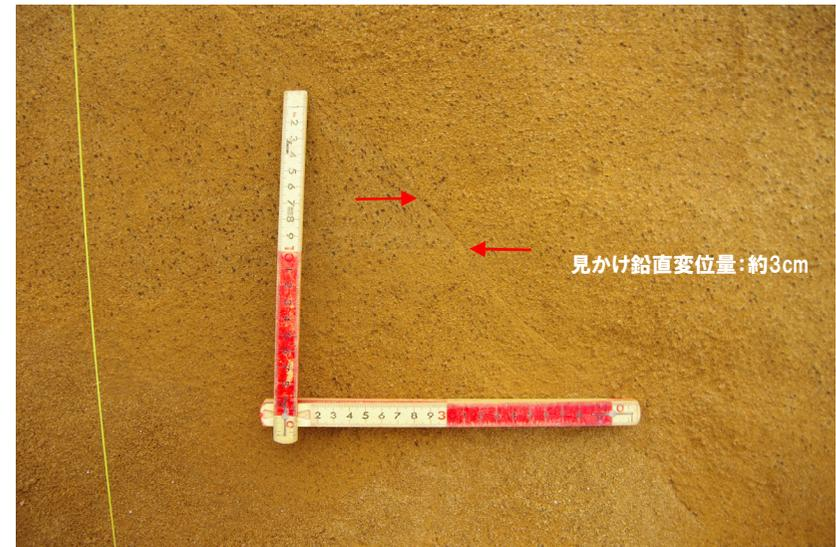
④-3 見かけ鉛直変位量計測箇所
