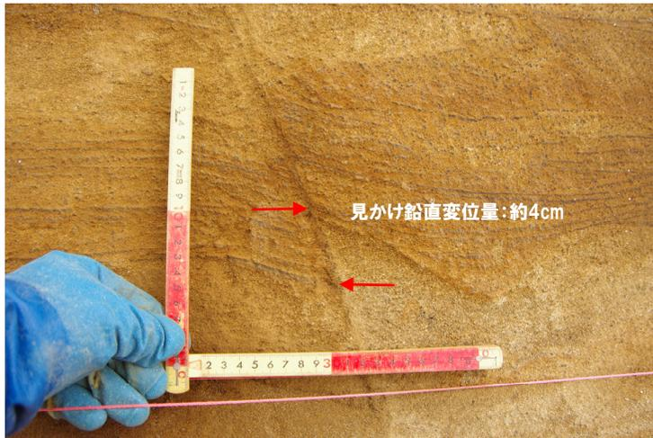
④-1 見かけ鉛直変位量計測箇所
