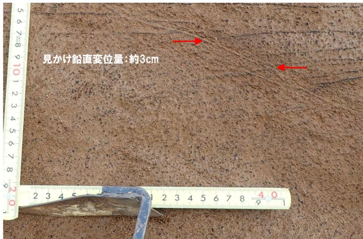
①-1 見かけ鉛直変位量計測箇所
