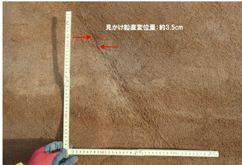
④-2 見かけ鉛直変位量計測箇所
