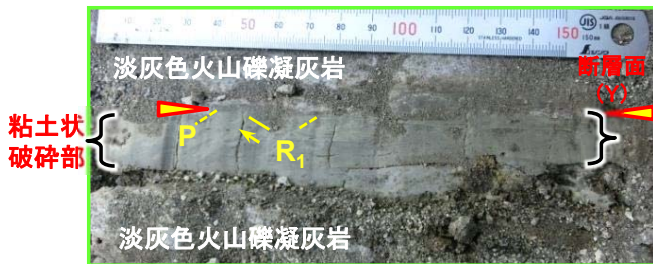
右横ずれセンスを示す断層の粘土状破砕部中の複合面構造
