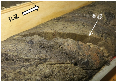
断層部コア接写写真(深度98.4m付近)
