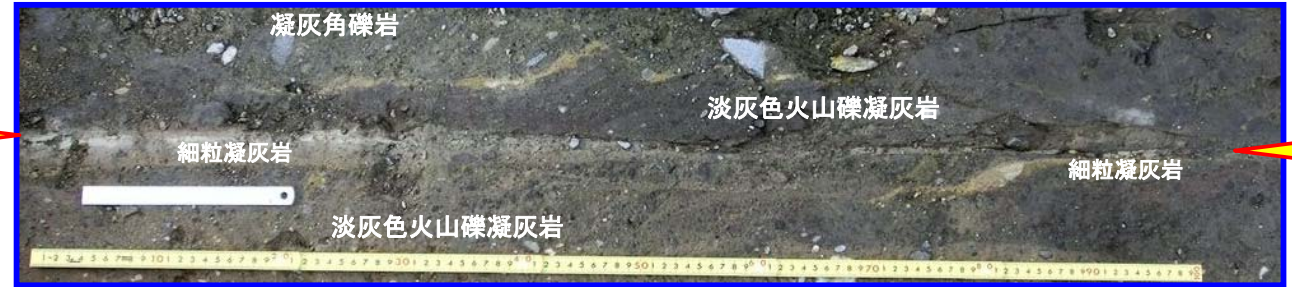
易国間層中の直線的な断層面とその近傍の右横ずれセンスを示す複合面構造
