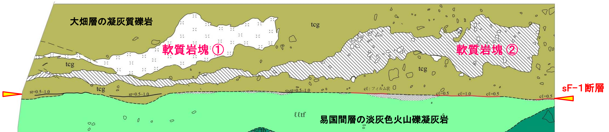
掘削面底盤Aの地質スケッチ
