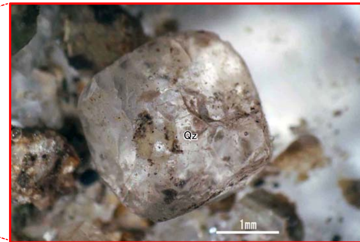
写真2-3 同左実体鏡拡大写真 敷地内試料と同様、粒径3mm程度の大きな石英粒子(いわゆる算盤玉状の結晶形を呈する)が認められる。
