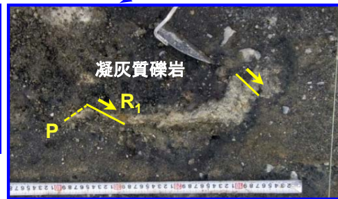
大畑層中の軽石の右横ずれ変形
