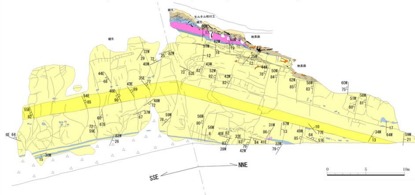
図 2 - 26 開削面露頭全景写真・スケッチ
