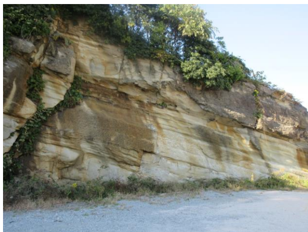
図 2-12 (6) 防波壁 (西端部) 露頭状況 P6 開削面露頭 火山礫凝灰岩～凝灰岩 C M ～C H 級
