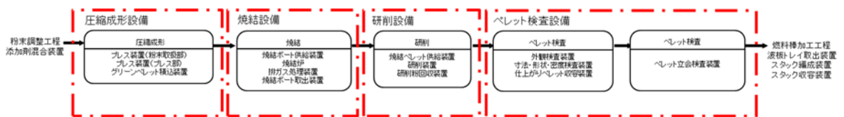
第4図 燃料製造における主な処理フロー (ペレット加工工程)
