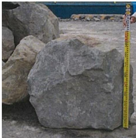
被覆石寸法（1, 2号炉北側護岸）
