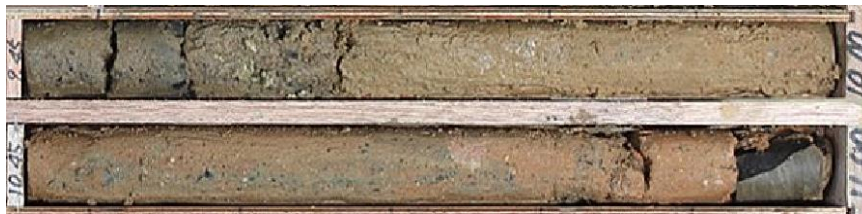
採取した埋戻土（粘性土）
