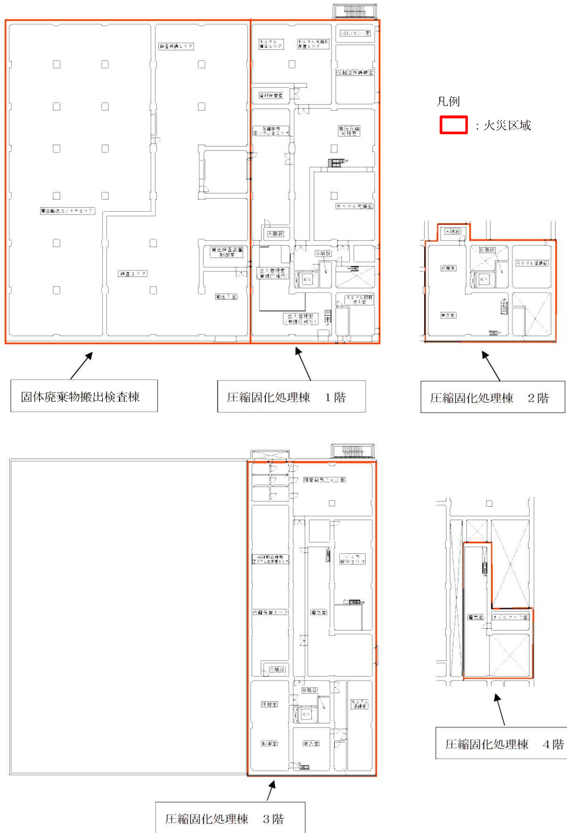
第8-1図 廃棄物搬出設備の火災区域(1/2)
