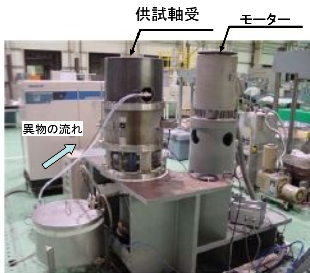
図-2 海水ポンプ軸受摩耗試験装置
