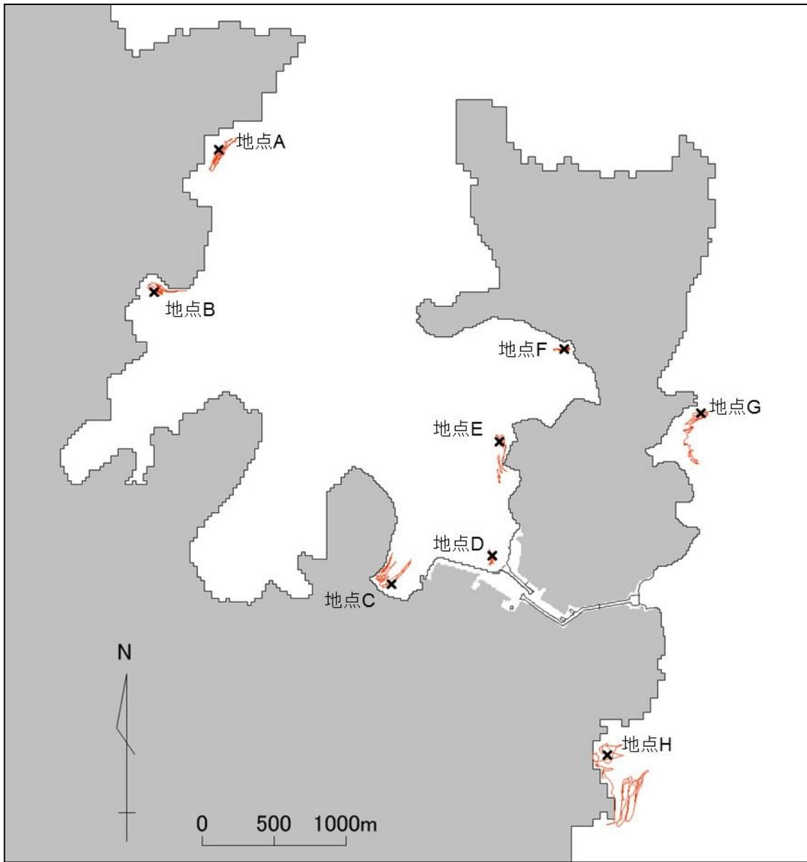
図-2-5-32 基準津波による漂流物の軌跡
