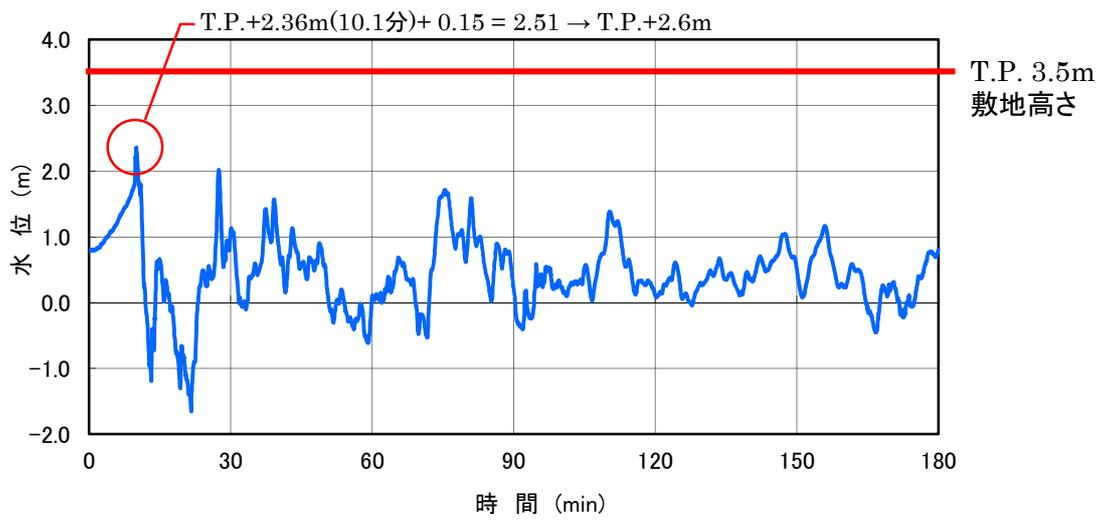
図-2-2-12 1号炉海水ポンプ室 津波波形
