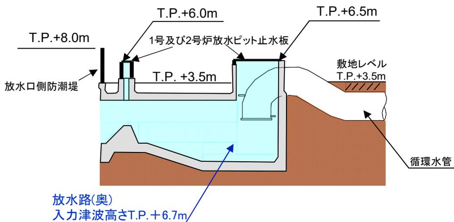
図-2-2-45 1号及び2号炉 放水ピット断面図
