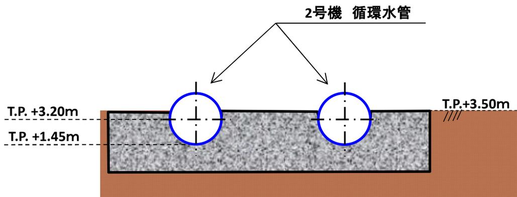
図-2-2-19 2号機循環水管埋設部 断面図③
