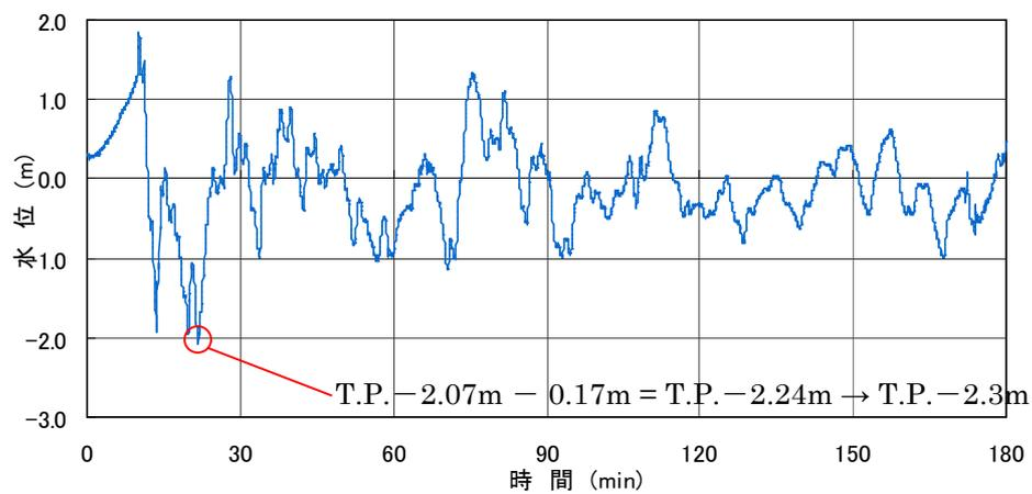
図-1-6-2 入力津波の時刻歴波形 (4/4)
