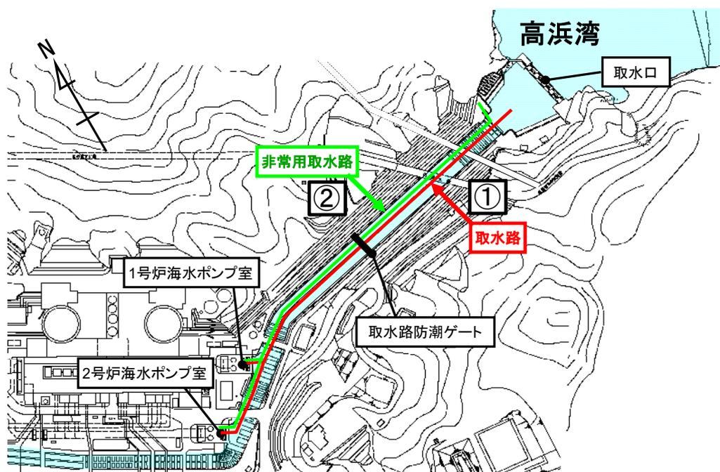
図-2-2-5 1, 2号炉海水取水系配置図
