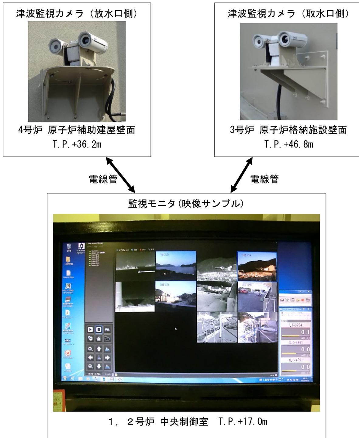
図 3-3-2 津波監視カメラ設備構成イメージ
