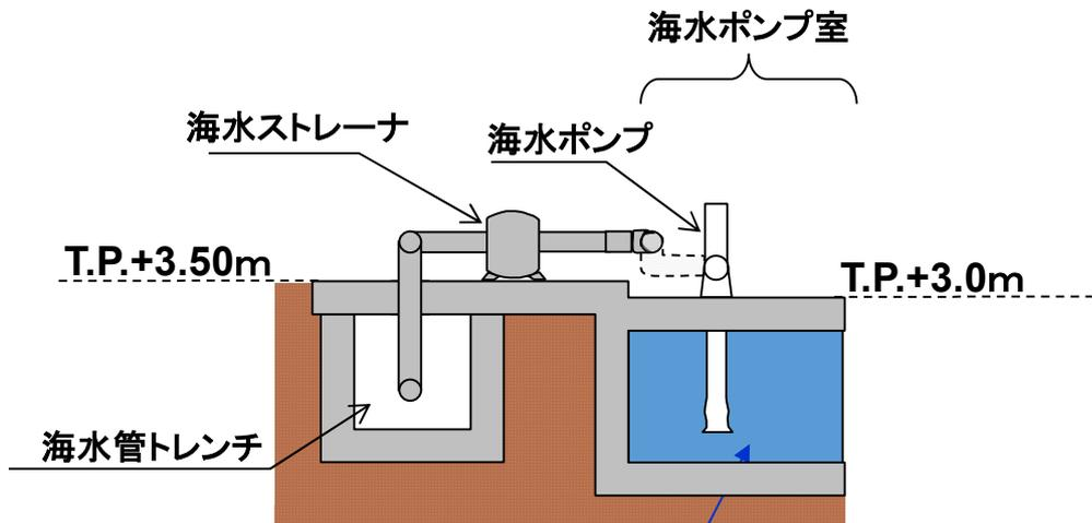
1号炉海水ポンプ室前面入力津波高さT.P.+2.6m
