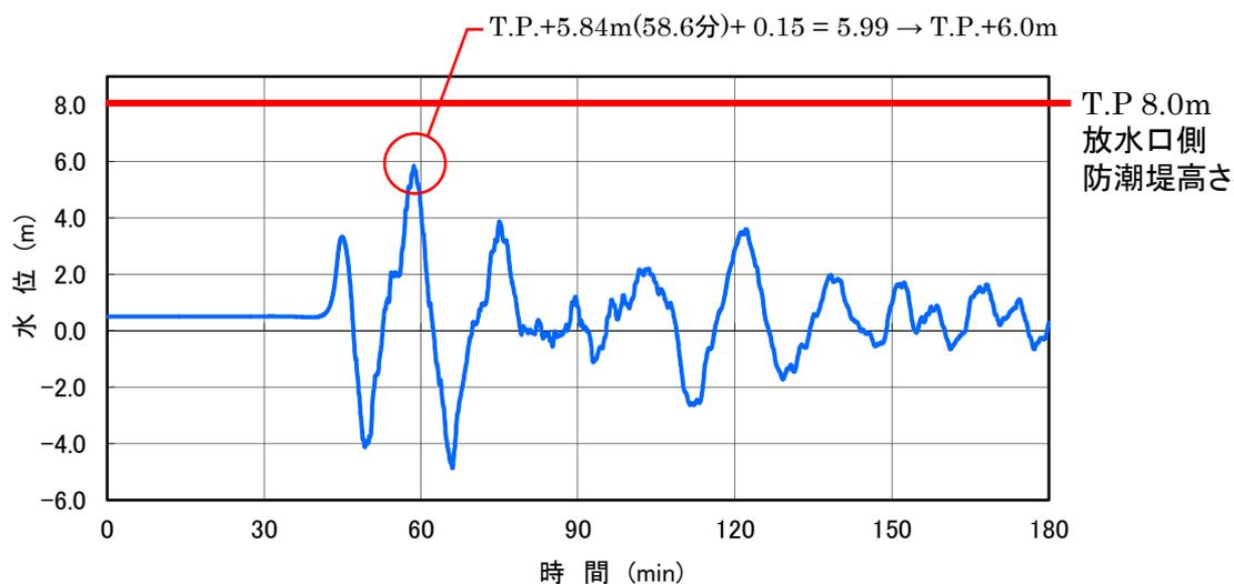
図-2-2-50 3号及び4号炉 放水口前面津波波形
