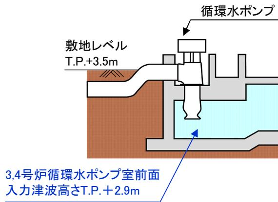
図-2-2-31 3, 4号炉循環水ポンプ室断面図
