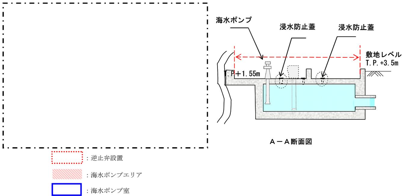
図-2-2-27 3,4号炉海水ポンプ室浸水対策箇所
