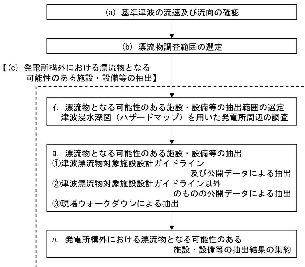
図-2-5-10 発電所構外漂流物抽出フロー
