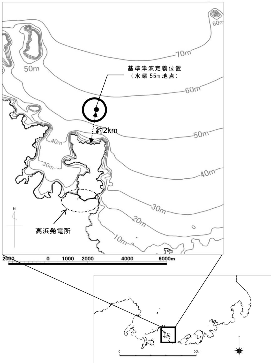
図 2 高浜発電所の基準津波定義位置
