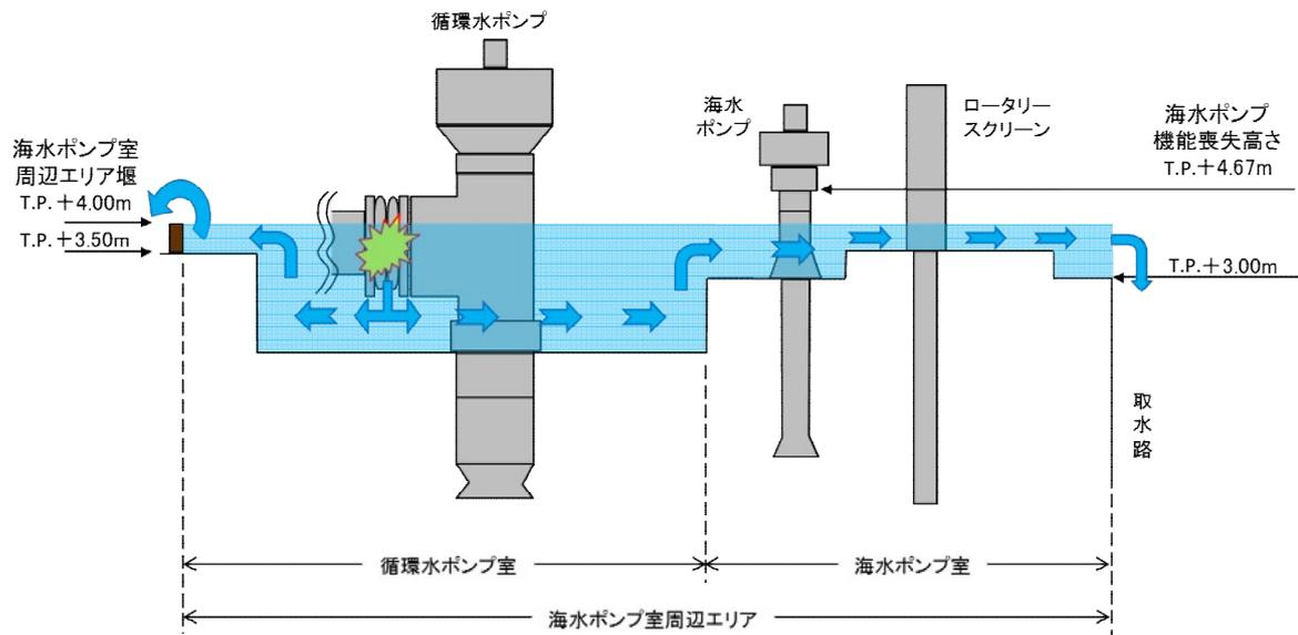
図-2-4-15 海水ポンプ室周辺エリア 断面図
