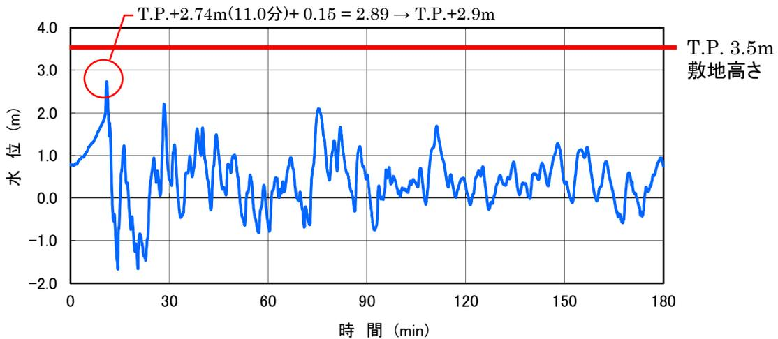
図-2-2-37 3,4号炉循環水ポンプ室 津波波形
