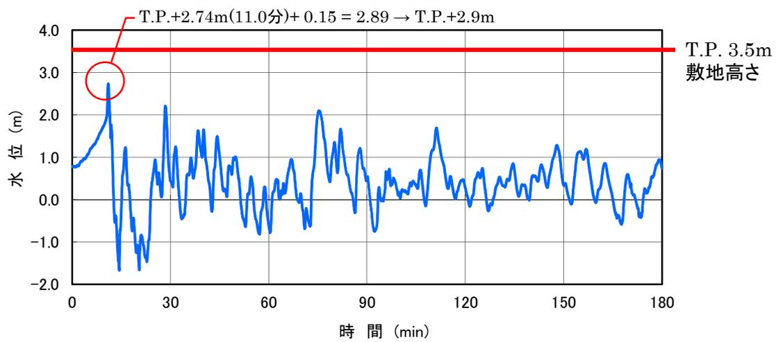
図-2-2-39 3,4号炉循環水ポンプ室 津波波形
