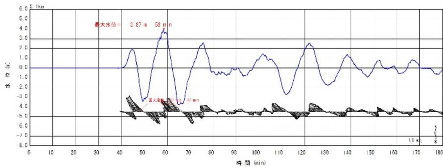
図-2-5-16 (4/4) 沿岸域において抽出した地点の水位、流向、流速
