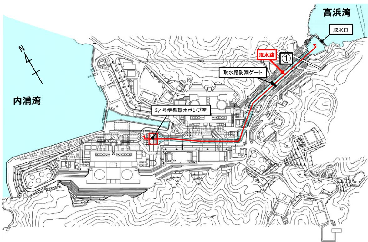
図-2-2-29 3, 4号炉海水取水系配置図
