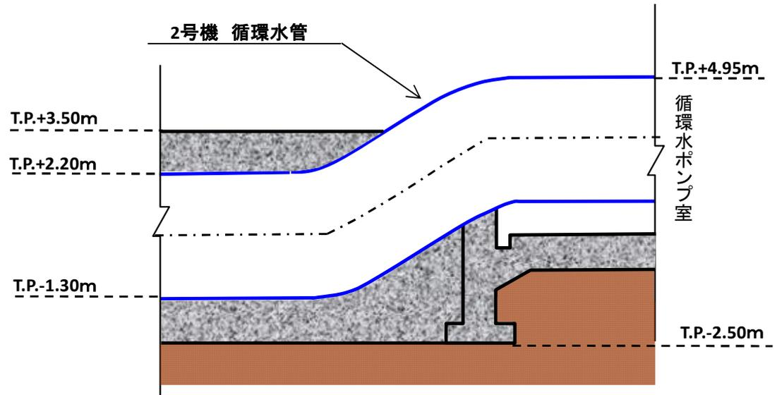
図-2-2-20 2号機循環水管埋設部 断面図④
