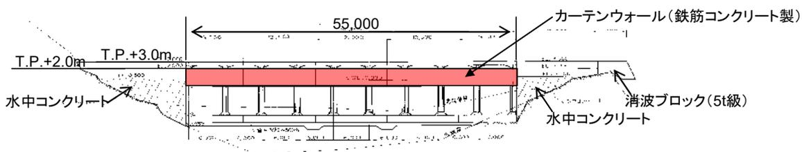
図-3-4-2 取水口カーテンウォール正面図
