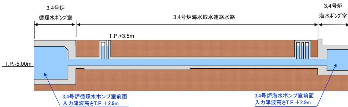
図-2-2-25 3,4号炉海水取水連絡水路断面図
