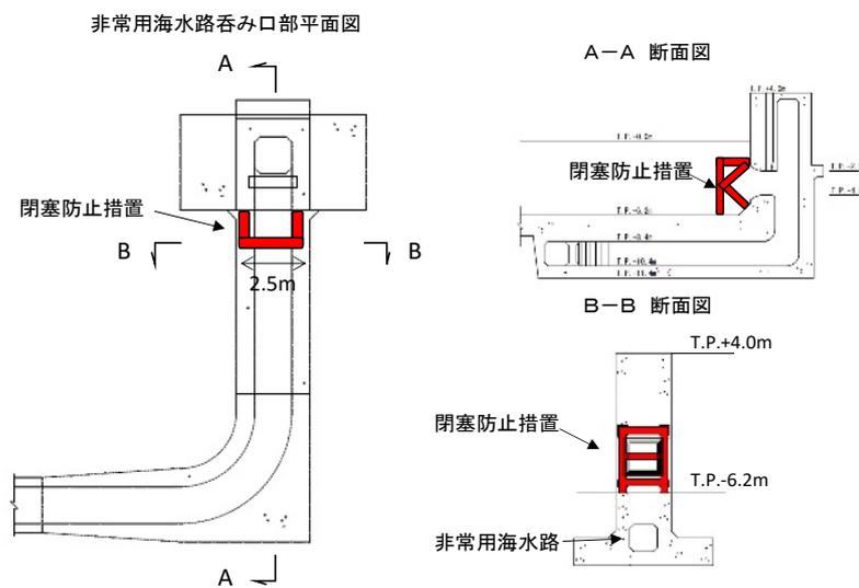
図-2-5-40 漂流物による閉塞防止措置
