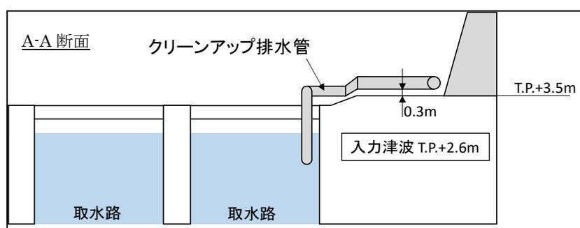
図-2-2-33 1号炉海水ポンプ室付近排水管路経路図
