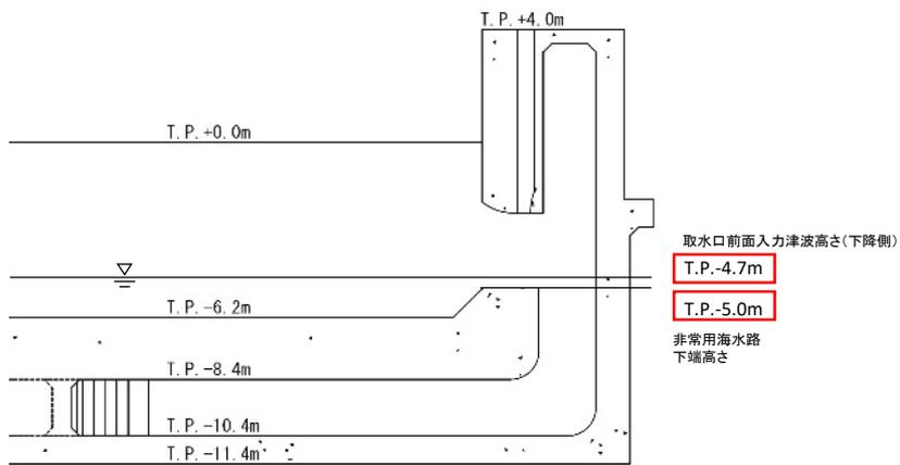
図-2-5-38 海水取水トンネル呑み口平面図・断面図
