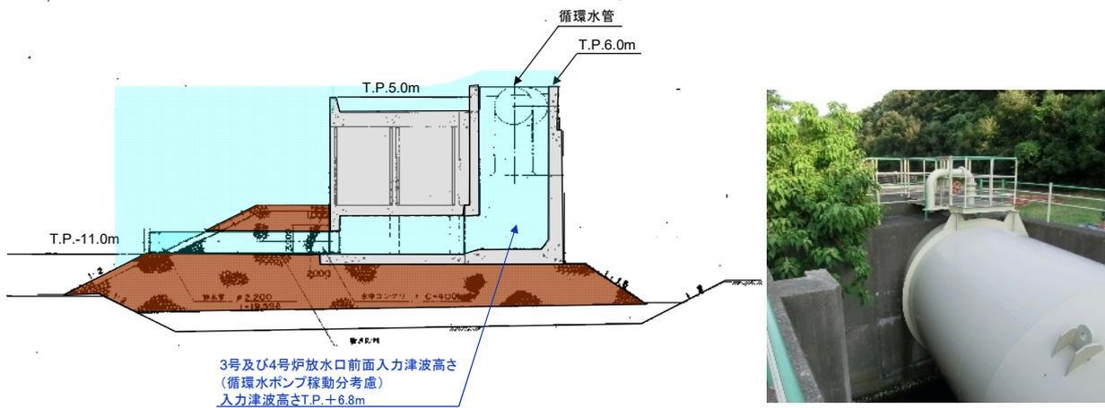
図-2-2-49 3号及び4号炉 放水路断面図
