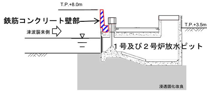
図-3-1-7 鉄筋コンクリート壁部
