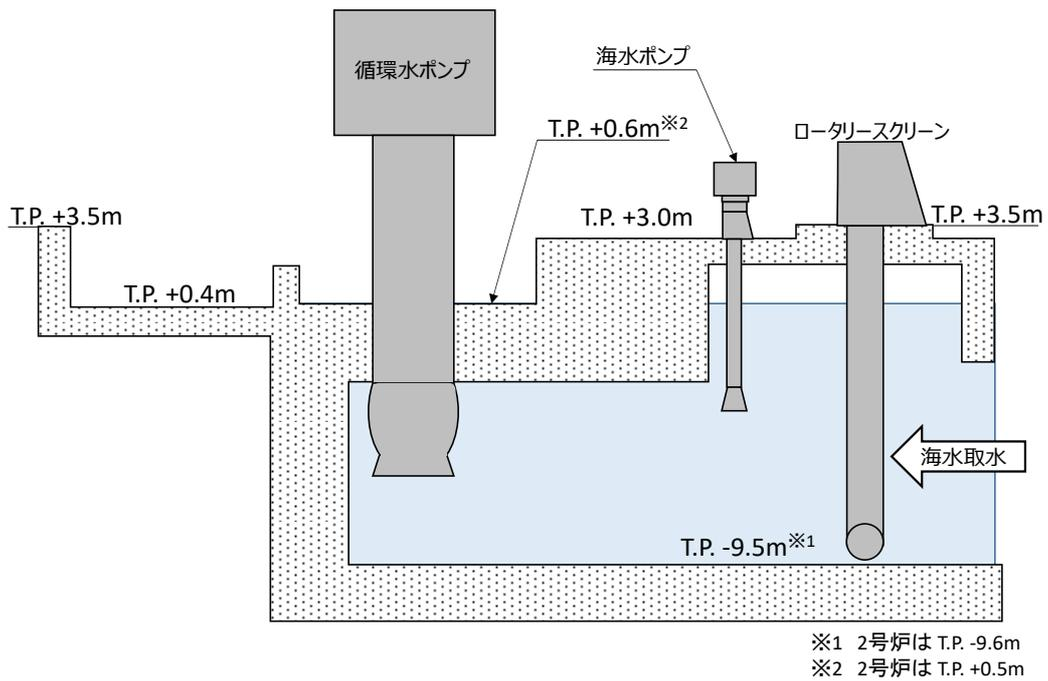
図-2-3-2 1号及び2号炉海水取水設備（断面図）
