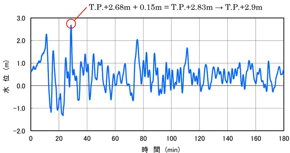
図-1-6-2 入力津波の時刻歴波形 (2/4)
