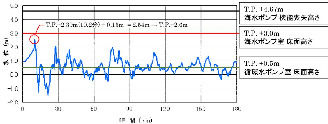
図-2-3-4 2号炉海水ポンプ室前津波波形
