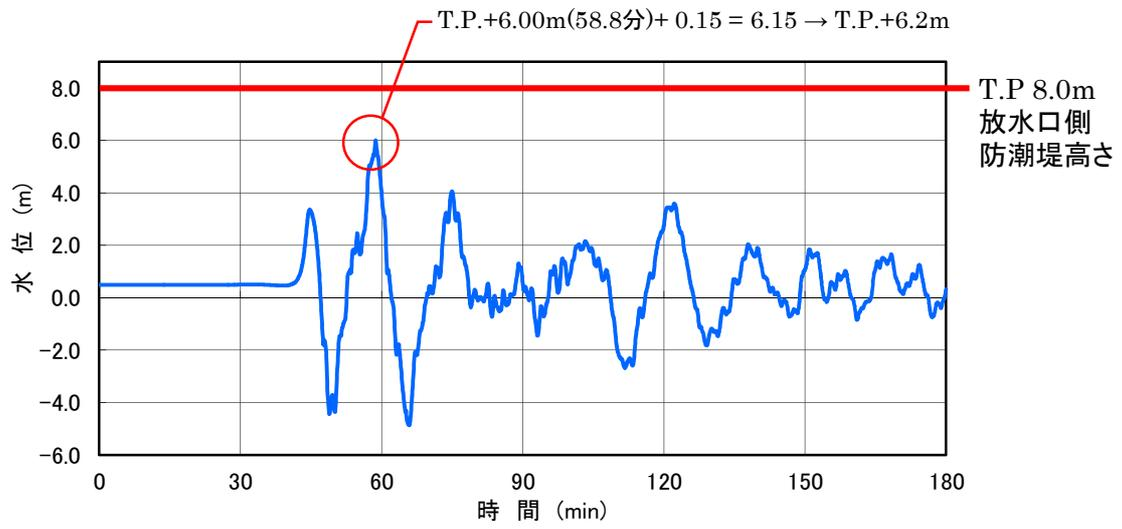
図-2-2-41 1号及び2号炉 放水口前面津波波形
