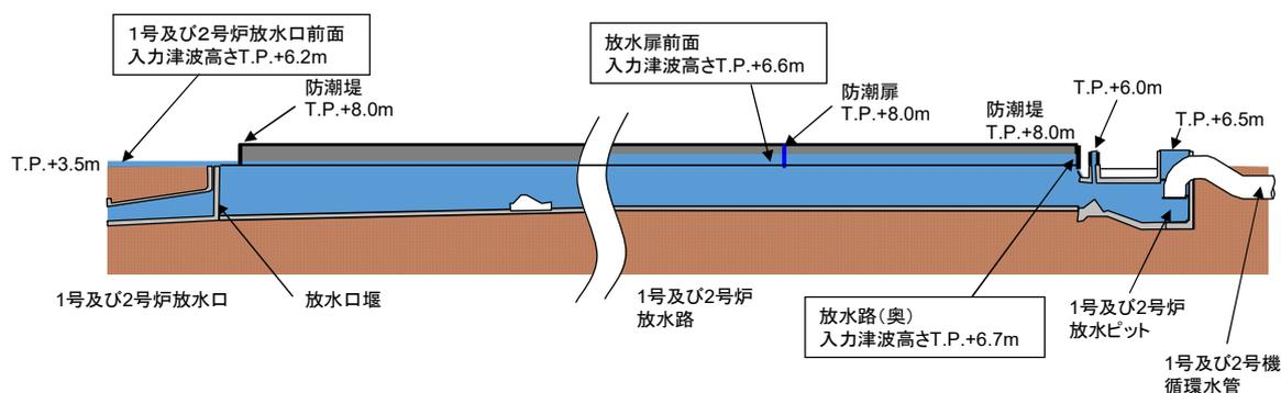
図-2-2-40 1号及び2号炉 放水路断面図
