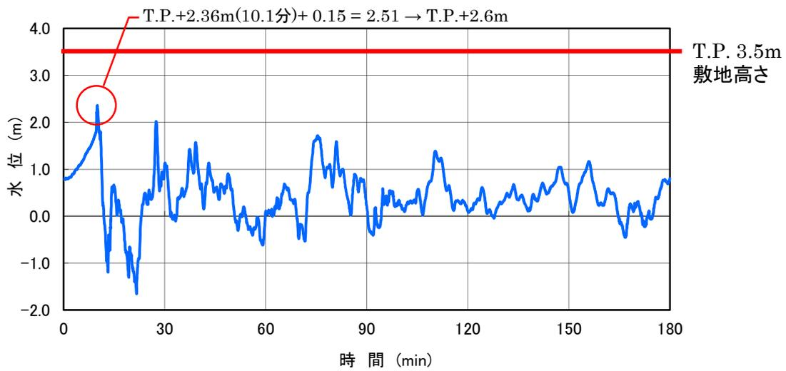
図-2-2-34 1号炉海水ポンプ室 津波波形
