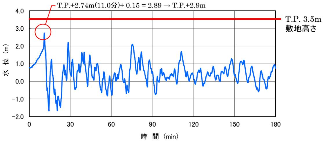
図-2-2-32 3, 4号炉循環水ポンプ室 津波波形
