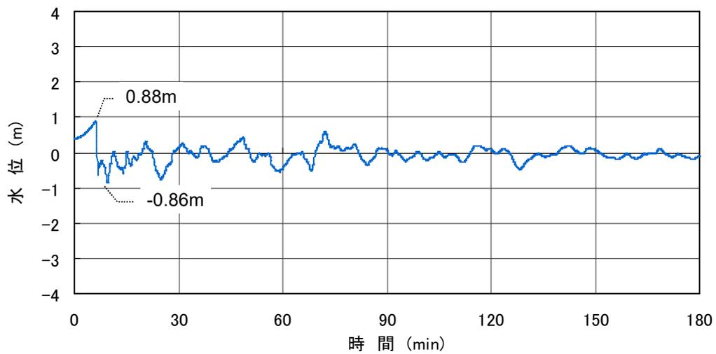
図 3 (1/2) 高浜発電所の基準津波
