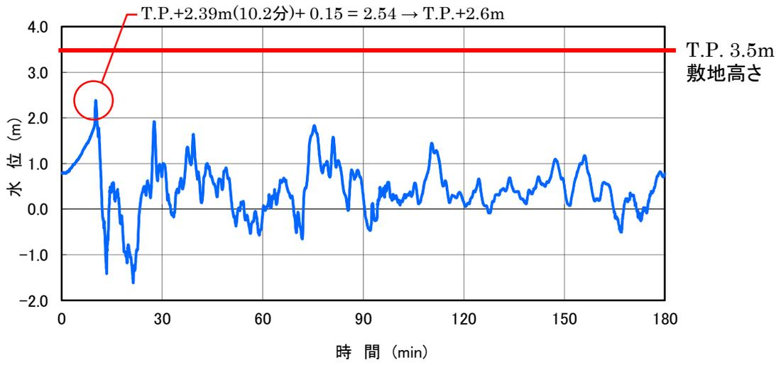
図-2-2-21 2号炉海水ポンプ室 津波波形
