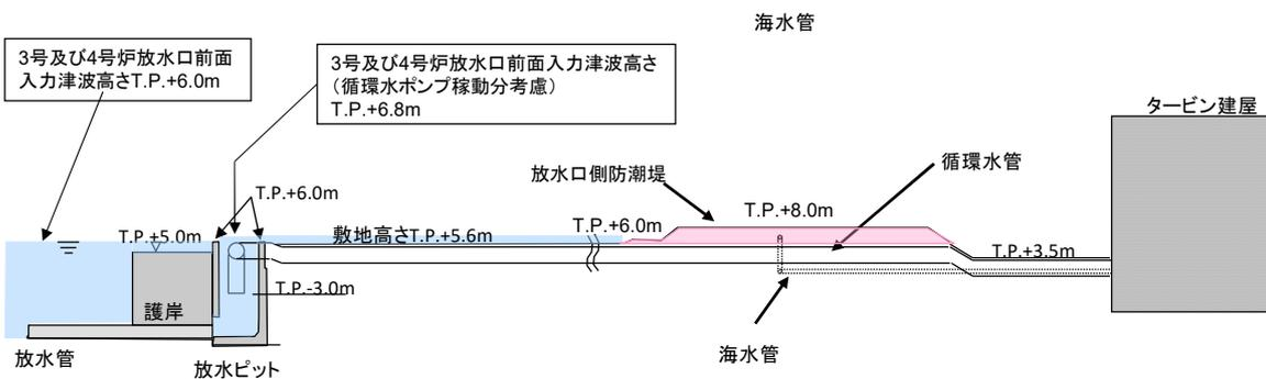
図-2-2-48 3号及び4号炉 放水路系配置図
