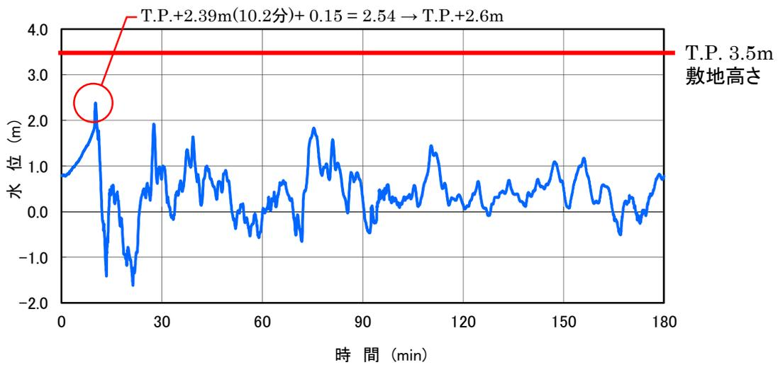
図-2-2-36 2号炉海水ポンプ室 津波波形
