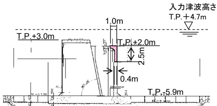
図-3-4-3 取水口カーテンウォール断面図
