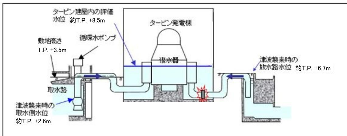
図-2-4-7 タービン建屋内の評価水位と取水側水位及び放水ピット側水位の概略図
