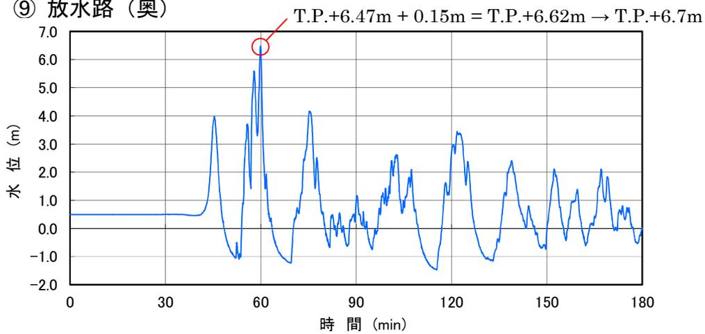
図-1-6-2 入力津波の時刻歴波形 (3/4)
