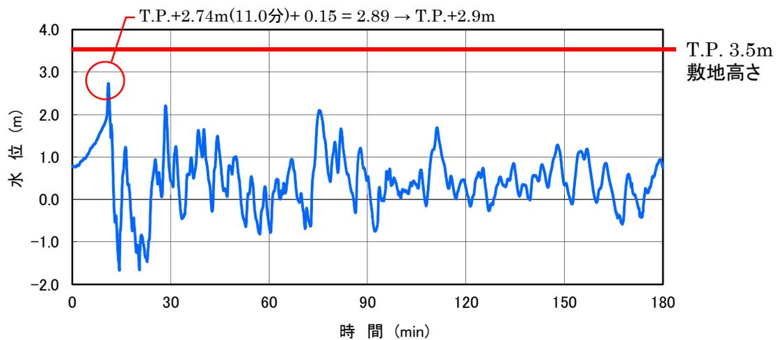
図-2-2-26 3,4号炉循環水ポンプ室 津波波形
