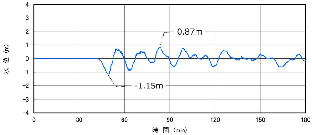
図 3 (2/2) 高浜発電所の基準津波
