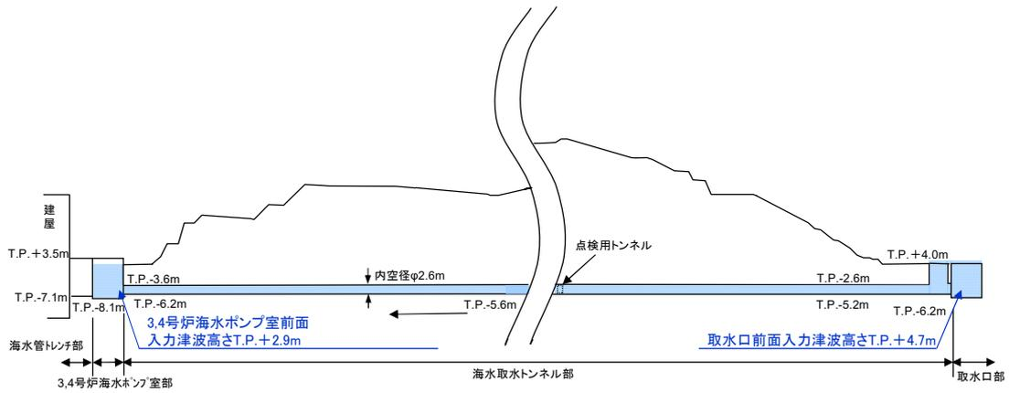
海水取水トンネル断面図
