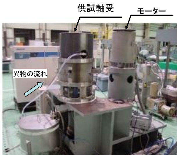
図-2 海水ポンプ軸受摩耗試験装置
