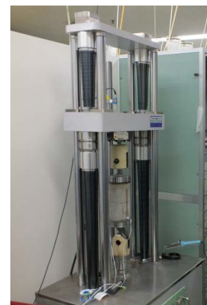
試験体及び付着力試験方法の概要(レベルコンクリート-基礎コンクリート)
