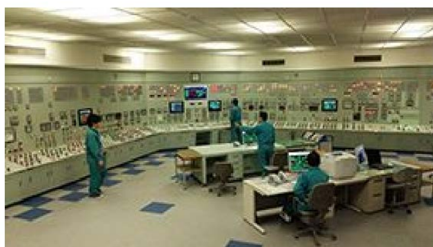
シミュレータを用いた運転操作訓練の状況 （写真は自社施設での実施状況，電源喪失時を想定）
