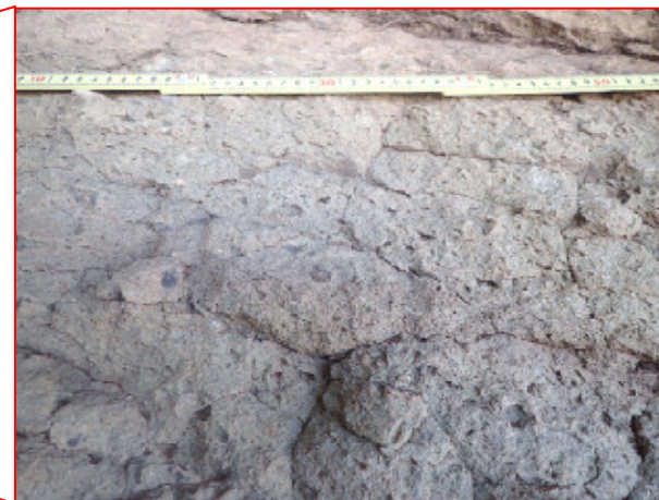
露頭拡大写真 露頭表面の扁平な空隙
