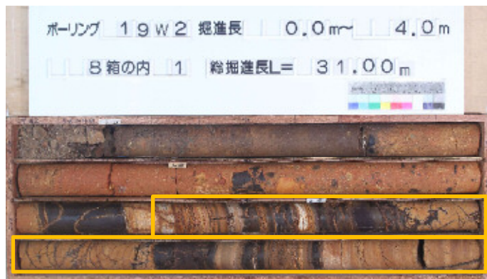
層準対比 19W2孔コア写真(G.L.0.0~-4.0m) 露頭で確認できる層準を橙四角で示す。
