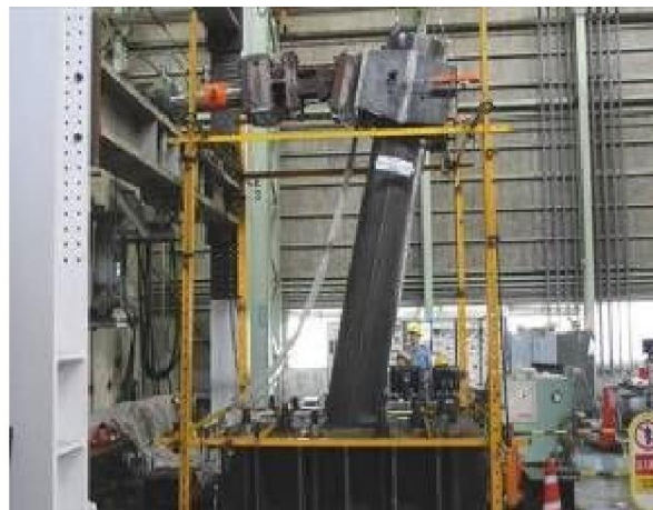
第6 図 最大荷重時座屈状況
