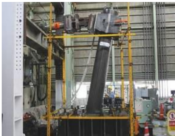
最大荷重時座屈状況
