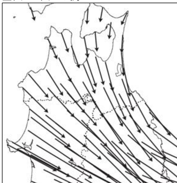
十和田周辺の地震後7年間の累積変位 (国土地理院, 2018 より抜粋)
