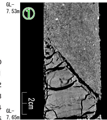
・周辺の堆積構造の傾斜は概ね20°以下であるが、深度7.6m付近では傾斜約45°の層相境界が認められる。
