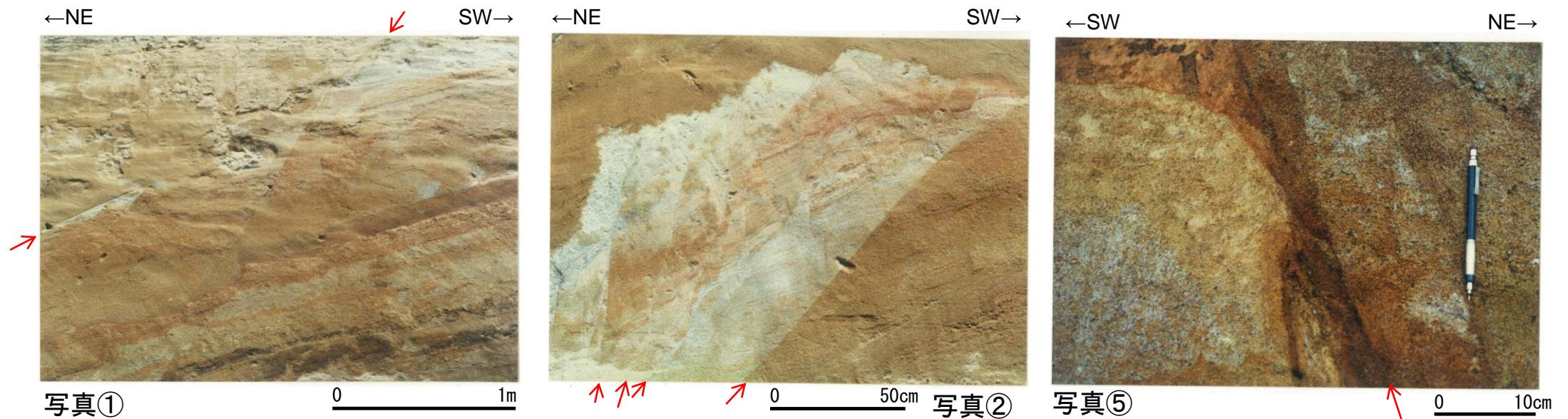
・すべり面(小断層群)は、幅1mm~5mm程度の正断層であり、酸化鉄やマンガンが濃集する場合がある。
