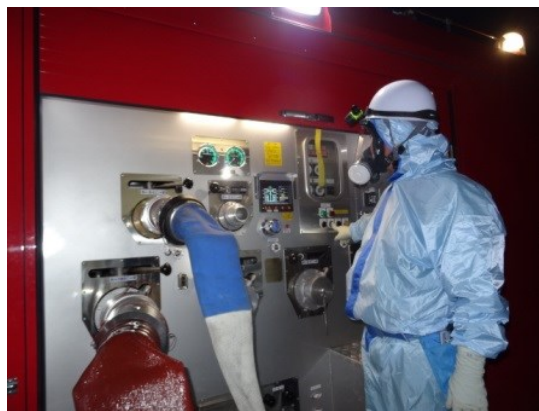
ポンプ起動操作（夜間）
