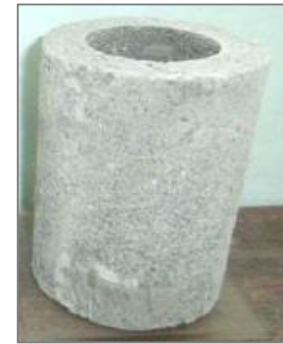
液状化強度試験供試体の例 (凍結サンプリング(A2s層))
