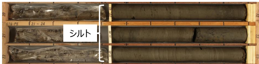
(b) 沖積層上部 (シルト質) (GTG-P5) のコア写真
