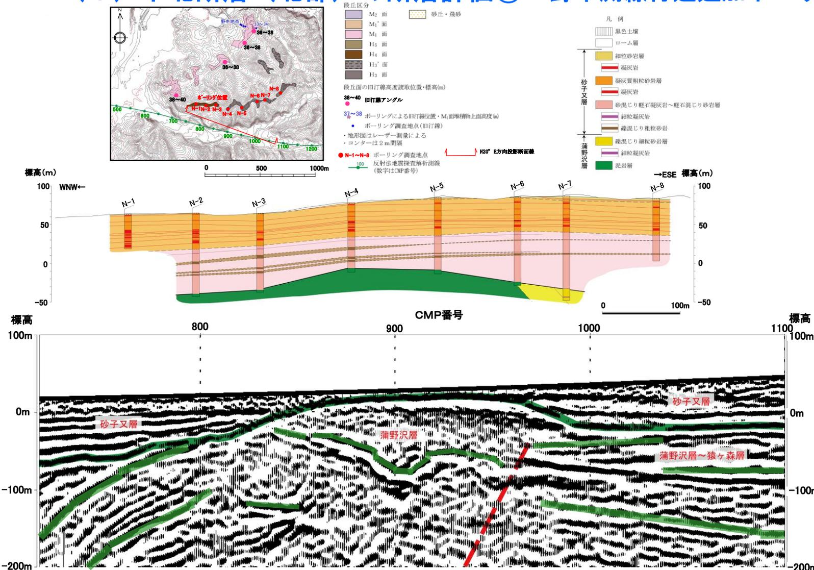
➤ ボーリング調査の結果、反射断面と同様の蒲野沢層の背斜が確認され、それを覆う砂子又層は、鍵層の状況から、ほぼ水平に堆積し、断層の影響を示唆する変形等は認められないことを確認した。
