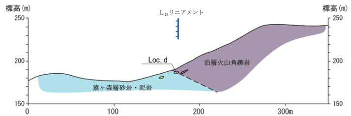
Loc.d 地質断面図・スケッチ
