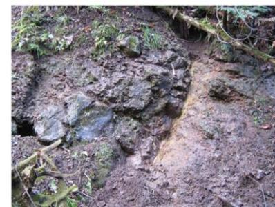
露頭③: 泊層凝灰角礫岩 西傾斜 55° 写真左右反転
