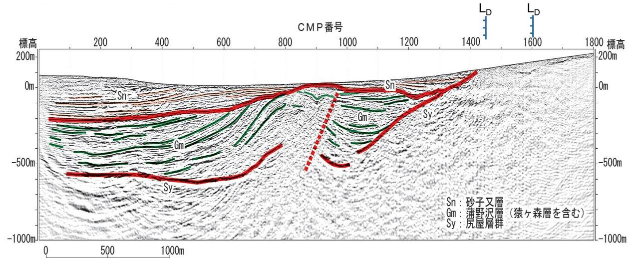
野牛測線の深度断面とその解釈
