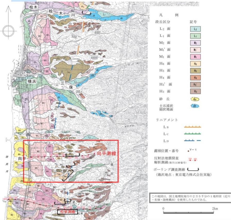
横浜断層南端部の空中写真判読図
