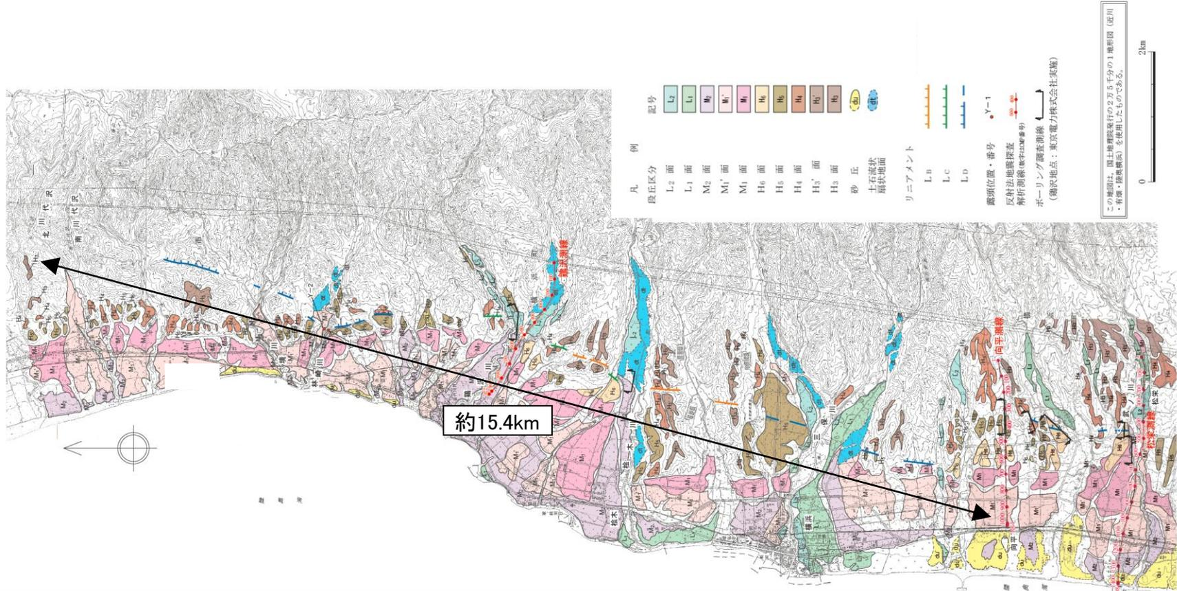
➤ 横浜断層は、洞爺火山灰(約11.5 万年前～約11.2 万年前)の層準に変位及び変形が認められ、阿蘇4火山灰(約9万年前～約8.5 万年前)の層準にも高度差があり、その高度差が断層活動により形成された可能性を否定できないことから、後期更新世の活動を考慮することとし、その長さを北川代沢から向平付近に至る約15.4km と評価する。
