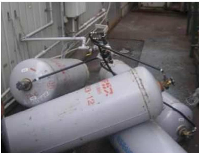
東日本大震災での LP ガスボンベの被災状況の一例<sup>3)</sup>
