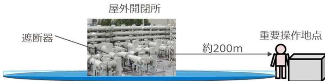
図2 六フッ化硫黄の評価点への到達イメージ
