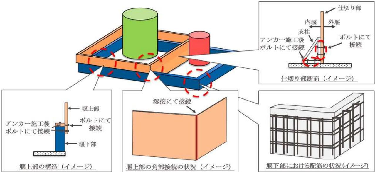
図 5 受動的に機能を発揮する設備（堰）の構造
