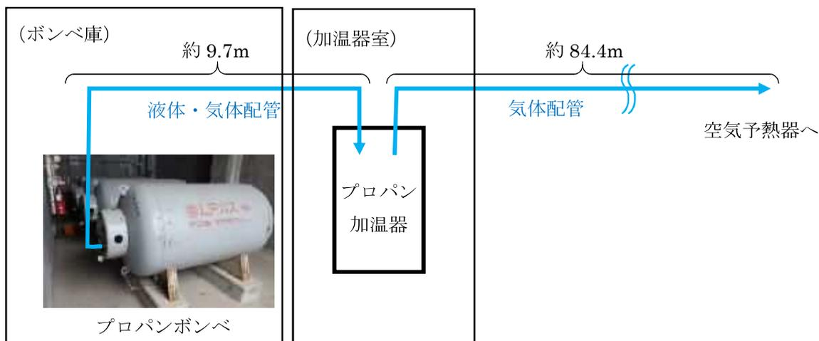
図 1,2号炉雑固体焼却炉のプロパンガス概略系統図
