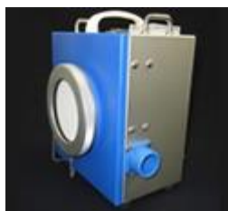
(可搬式ダスト・よう素サンプラの写真)
