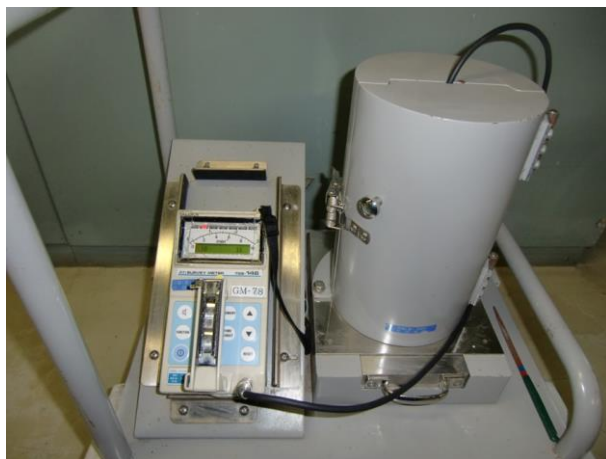
(空気中の放射性物質の濃度の測定の写真)
