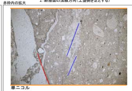
走向・傾斜 N6° E88° W X: 条線方向(下向きを正とする) Z: 断層面の法線方向(上盤側を正とする)
