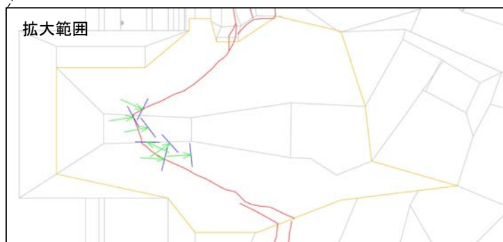
K断層の確認箇所(ピット, 地表面投影)
