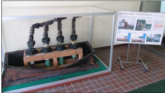
柏崎刈羽3号炉 所内変圧器の火災
