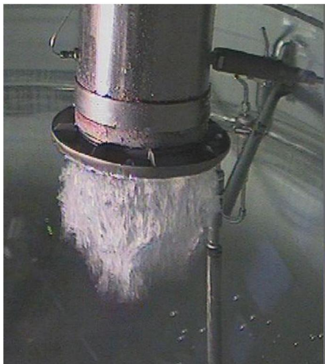
図 6-2 蒸気凝縮試験の様子
