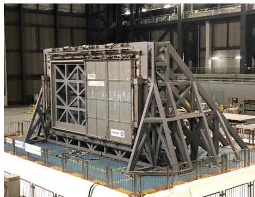
オペロBOP閉止装置加振試験状況
