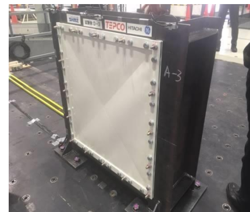
MSトンネル室BOP加振試験状況
