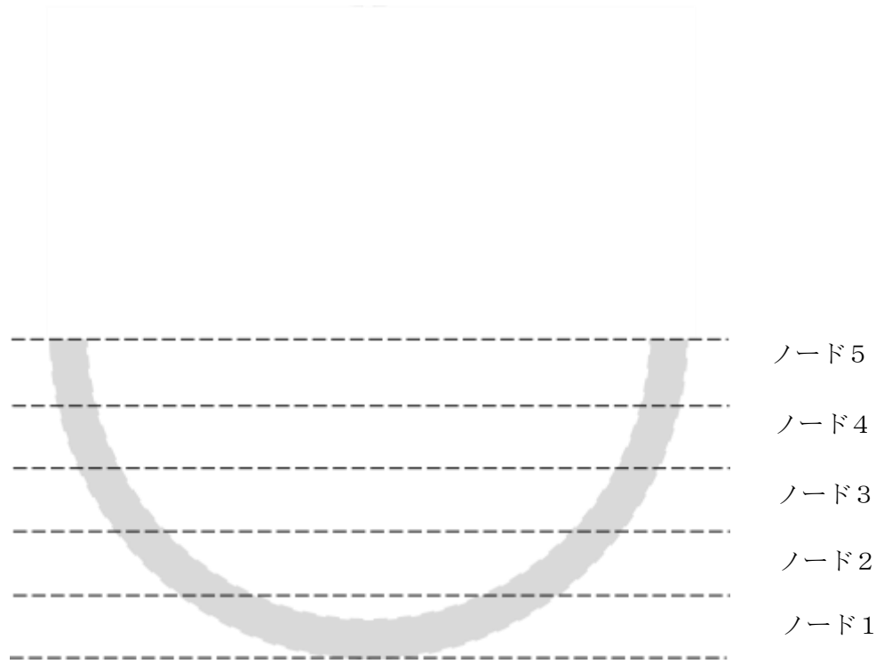
図1 原子炉圧力容器下部ヘッドのノード分割（概念図）
