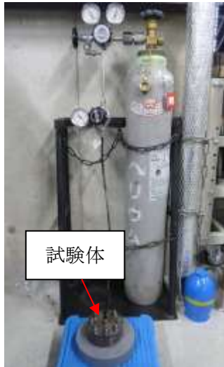
図5 He 気密確認試験状況
