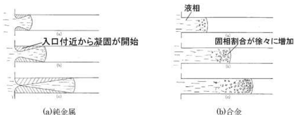
図別 2-1 流路内での溶融金属の凝固挙動の概念図
