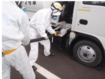
タンクローリへの燃料ホース接続
