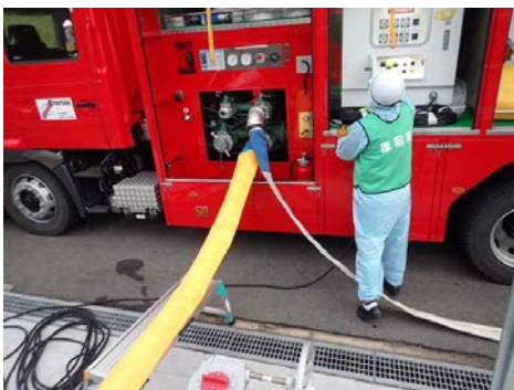
大量送水車起動
