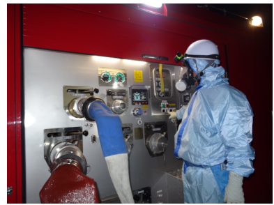
ポンプ起動操作（夜間）
