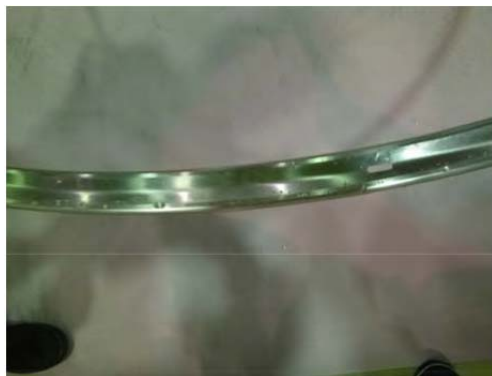
別添6-1図 中型乾式キャスク 金属ガスケット状況 [2]
