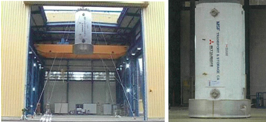
図 3 9.3m 頭部垂直落下試験時の試験体写真
