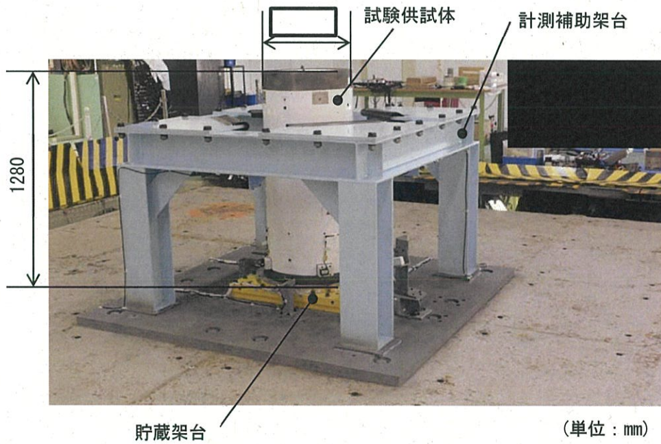
第 3-2 図 加振試験台上に設置された試験供試体
