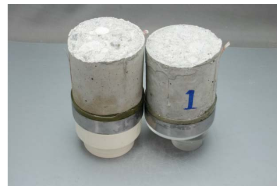
試験後の破断面の状況の例 (レベルコンクリート-基礎コンクリート)
