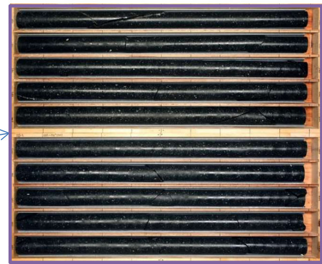
貫入岩(玄武岩) T.P.-553.87m~-563.87m(深度580m~590m)
