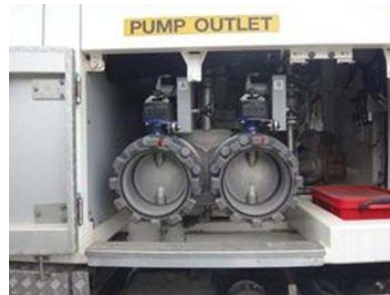
大型移送ポンプ車吐出部 可搬型建屋外ホース接続箇所 (300A)
