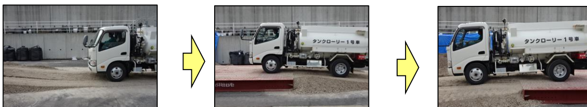
第4図 段差40cm復旧後の走行性能検証(2/2)
