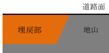
第3-9図 地山と埋戻部との境界部の状況
