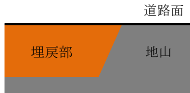
第 4-15 図 地山と埋戻部との境界部の状況
