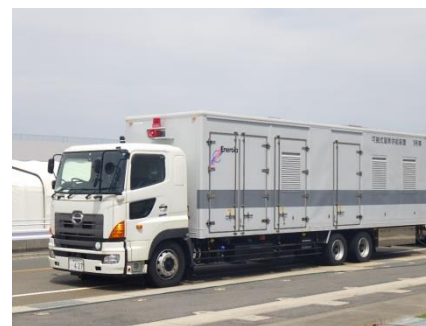
可搬型設備の対策実施例（可搬式窒素供給装置）
