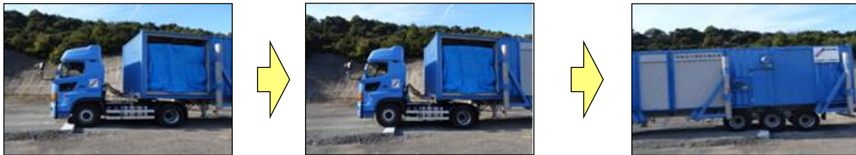
段差15cmの走行性能検証（移動式代替熱交換設備）
