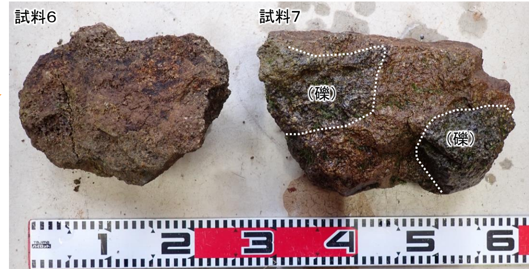
CT試料写真: 火山角礫岩
