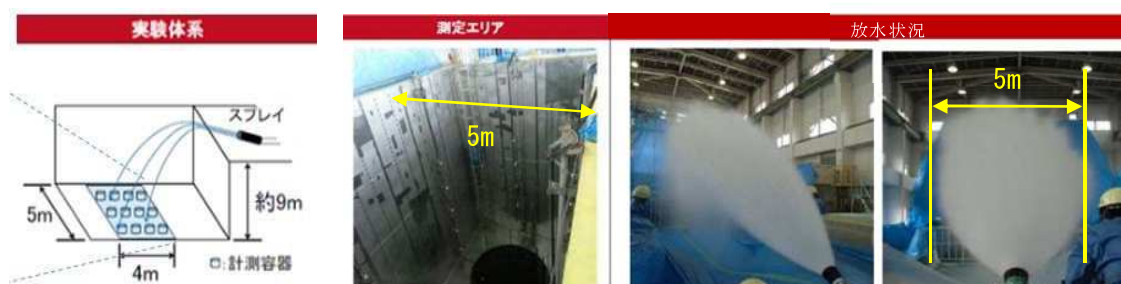
第3図 液滴径測定試験 試験体系および試験の様子
