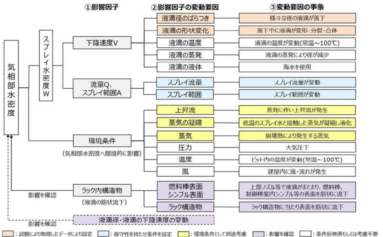
第2-4図 スプレイによる気相部水密度への影響
