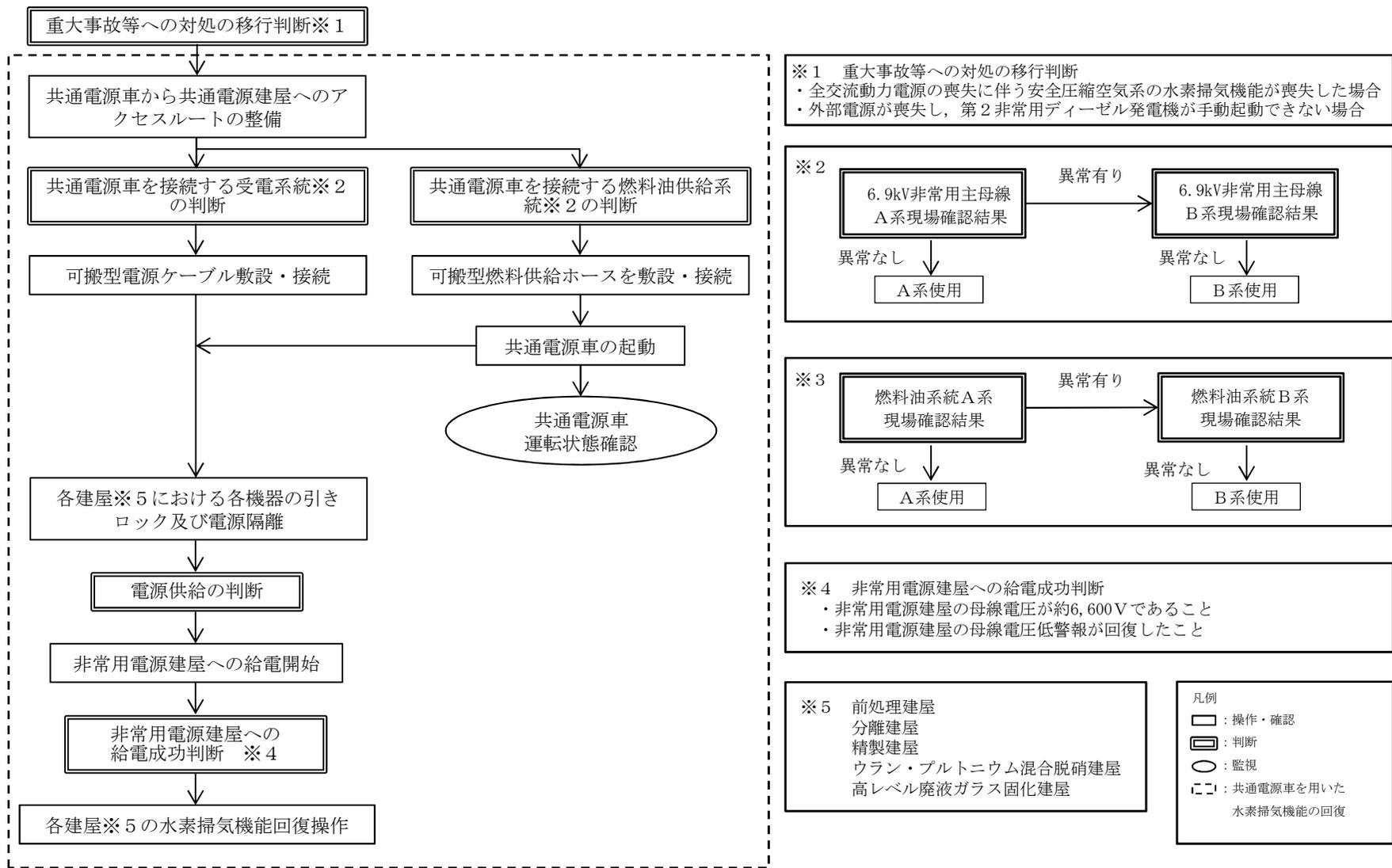
第1.3-14図 共通電源車を用いた水素掃気機能の回復の手順の概要
