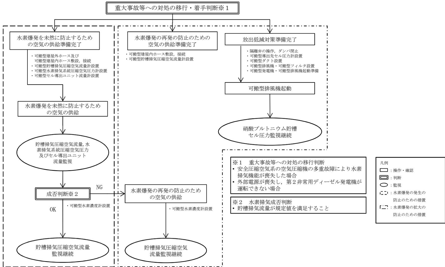
第1.3-6 図 ウラン・プルトニウム混合脱硝建屋の水素爆発の発生及び拡大の防止のための措置の手順の概要
