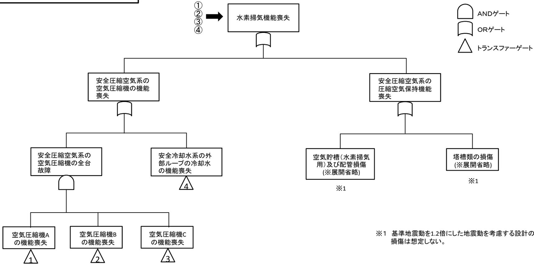
※1 基準地震動を1.2倍にした地震動を考慮する設計のため、損傷は想定しない。
