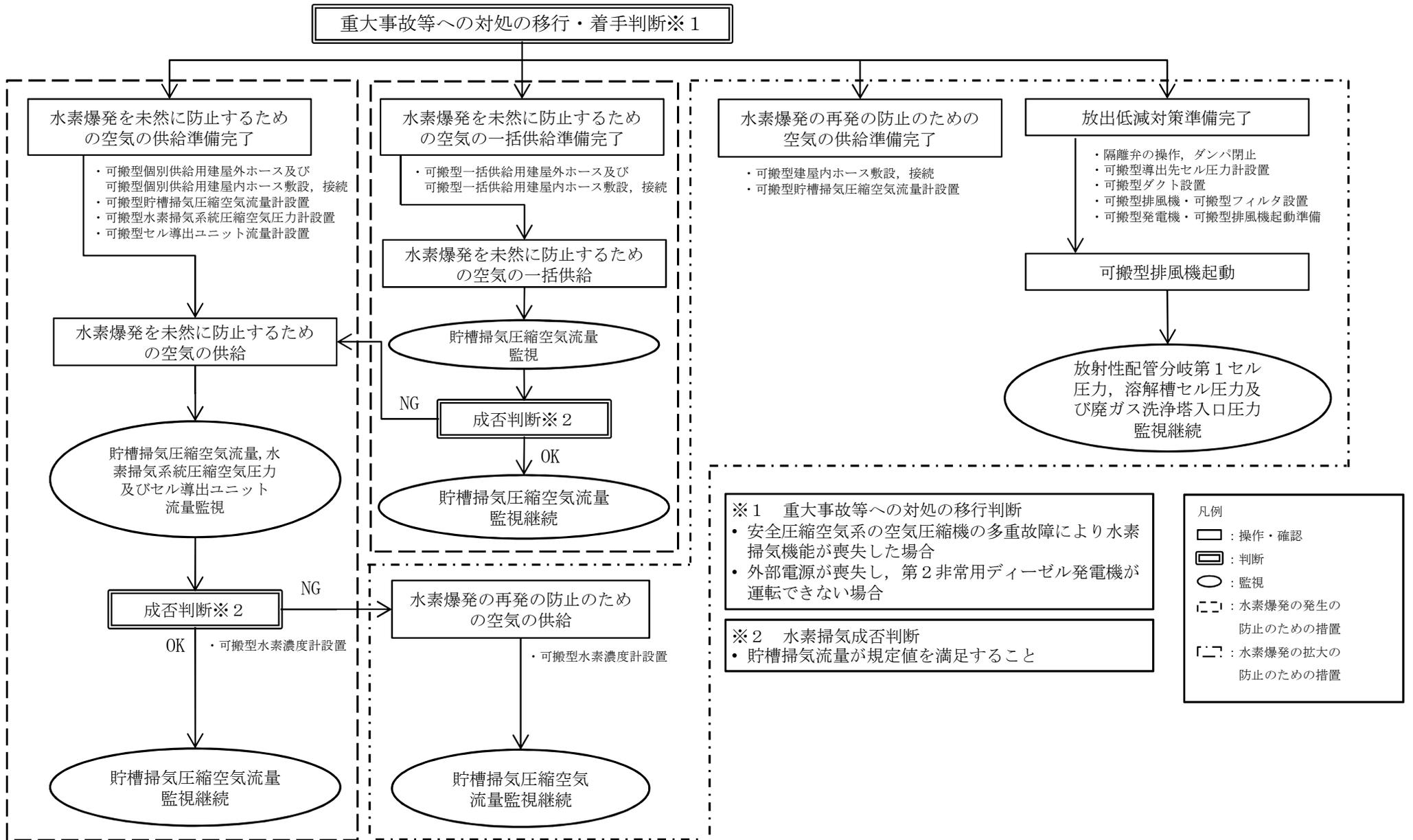
第1.3-3図 前処理建屋の水素爆発の発生及び拡大の防止のための措置の手順の概要
