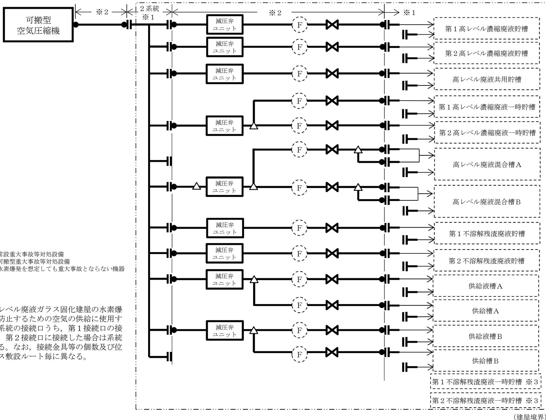
第1.3-24図 高レベル廃液ガラス固化建屋の水素爆発の再発を防止するための空気の供給の系統概要図
