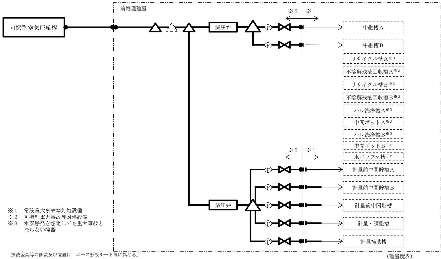
第1.3-8図 前処理建屋の水素爆発を未然に防止するための空気の供給の系統概要図 (2 / 2)
