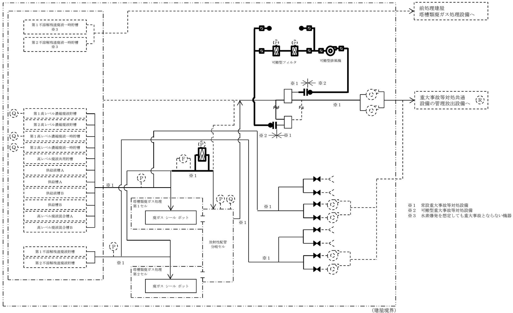
第1.3-31図 高レベル廃液ガラス固化建屋の放出低減対策の系統概要図
