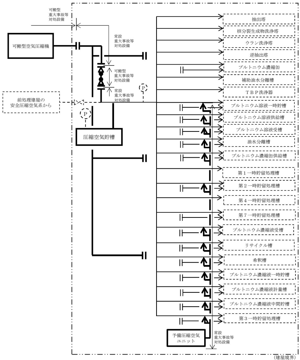
本図は、精製建屋水素爆発の2系統のうち1系統の第1接続口の接続例である。精製建屋水素爆発の他の1系統に接続した場合も同様の系統である。ただし、第2接続口への接続は接続金具等の個数及び位置は、ホース敷設ルート毎に異なる。
