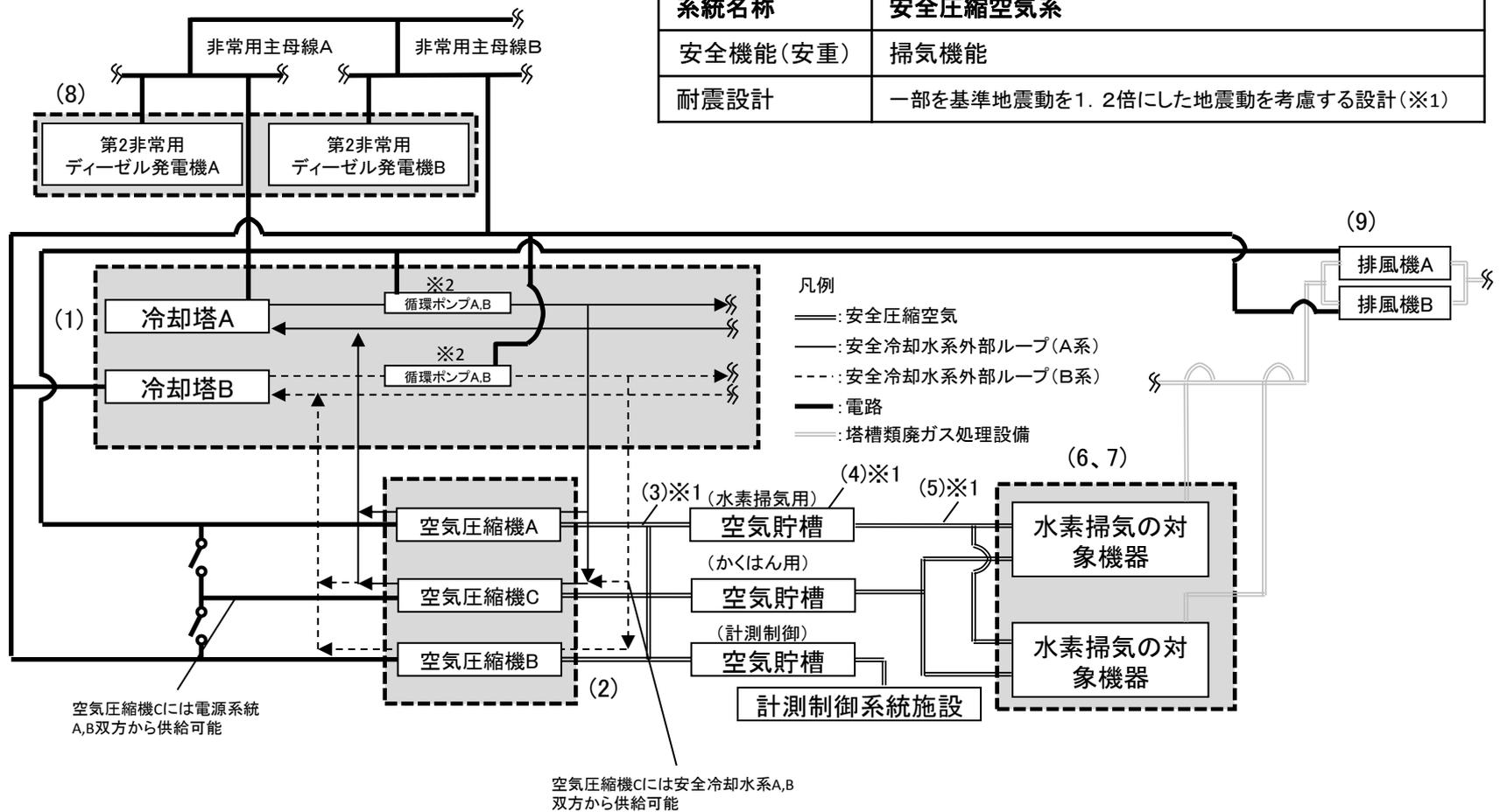
※2: 各々のシステムの冷却水ポンプA, Bは、それぞれ非常用電源A, Bから受電している。(例えば、安全冷却水A系の循環ポンプAは非常用母線Aから、循環ポンプBは非常用母線Bから受電)
