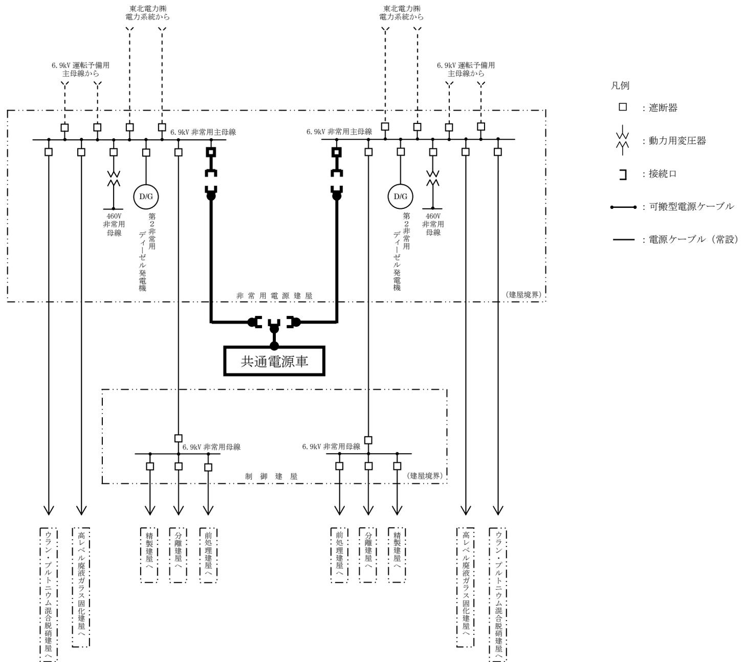
第 1.3-15 図 共通電源車を用いた水素掃気機能の回復の単線結線図
