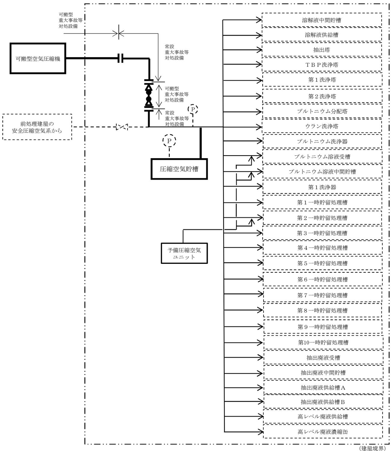
本図は、分離建屋水素爆発の2系統のうち1系統の第1接続口の接続例である。分離建屋水素爆発の他の1系統及び第2接続口に接続した場合も同様の系統である。ただし、接続金具等の個数及び位置は、ホース敷設ルート毎に異なる。
