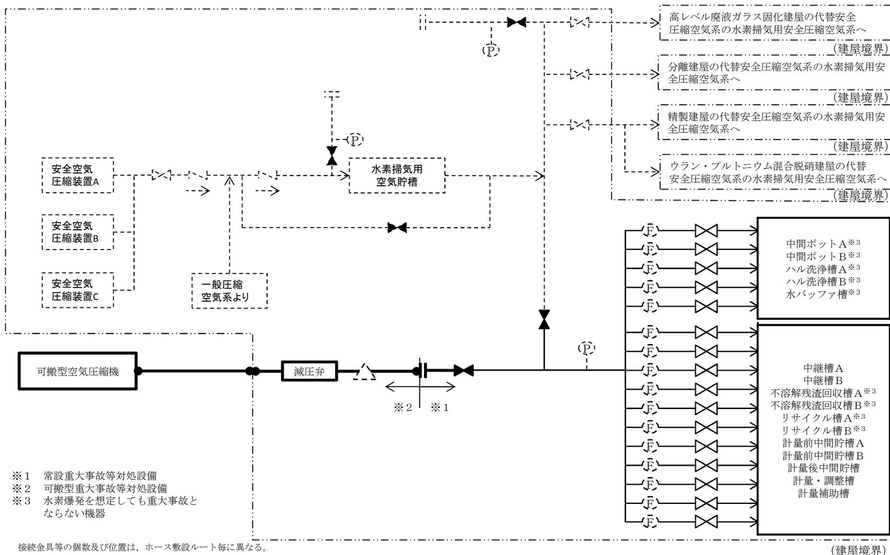
第1.3-8図 前処理建屋の水素爆発を未然に防止するための空気の供給の系統概要図 (1 / 2)
