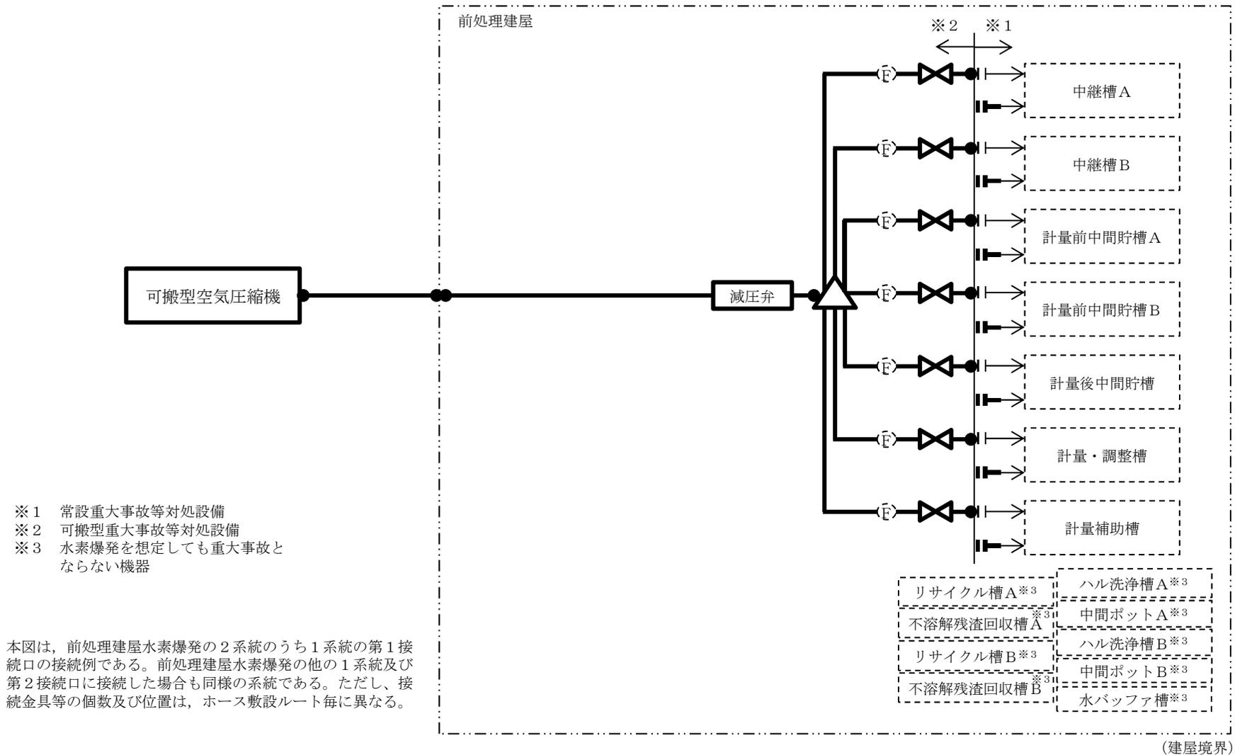
第1.3-20図 前処理建屋の水素爆発の再発を防止するための空気の供給の系統概要図
