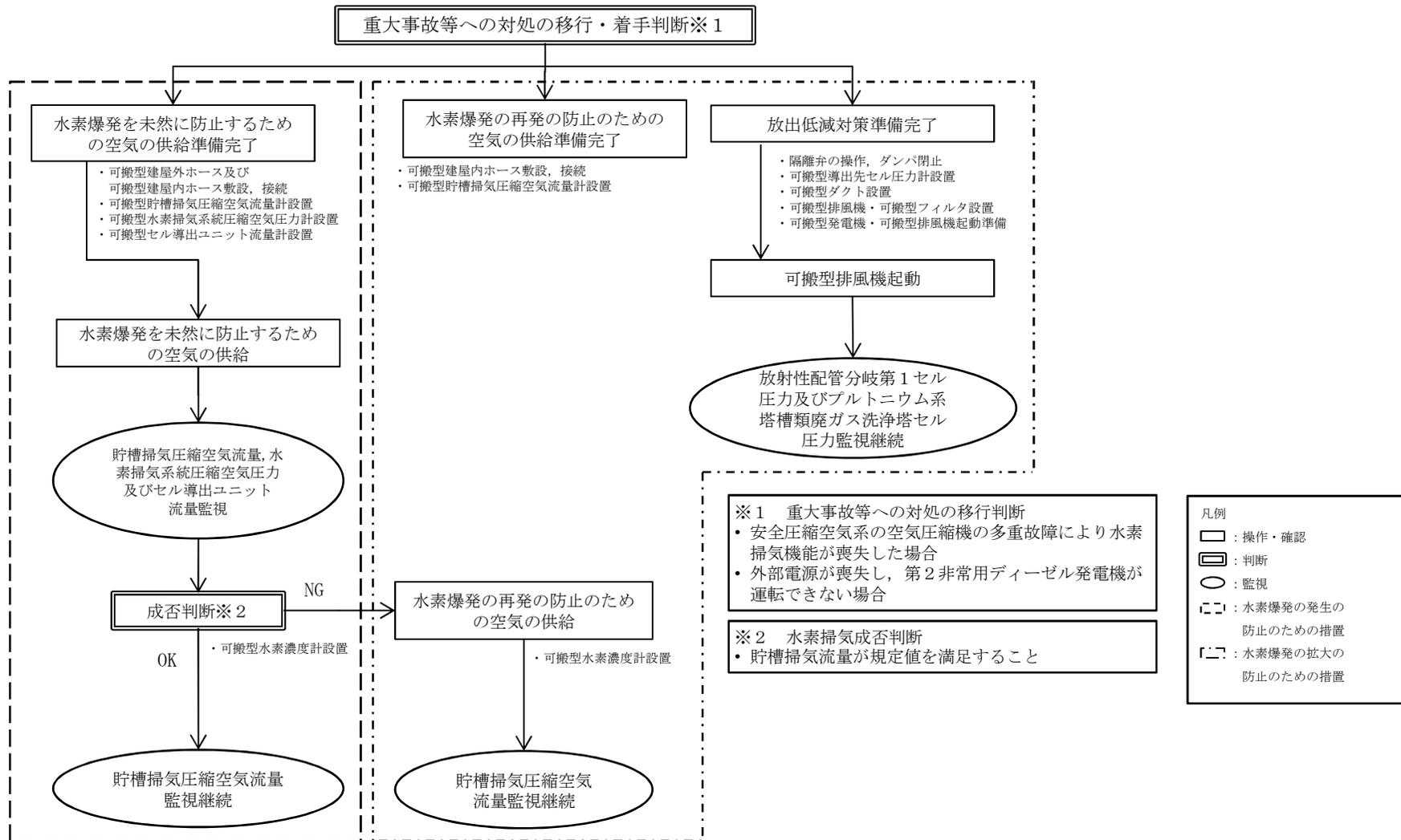
第1.3-5 図 精製建屋の水素爆発の発生及び拡大の防止のための措置の手順の概要
