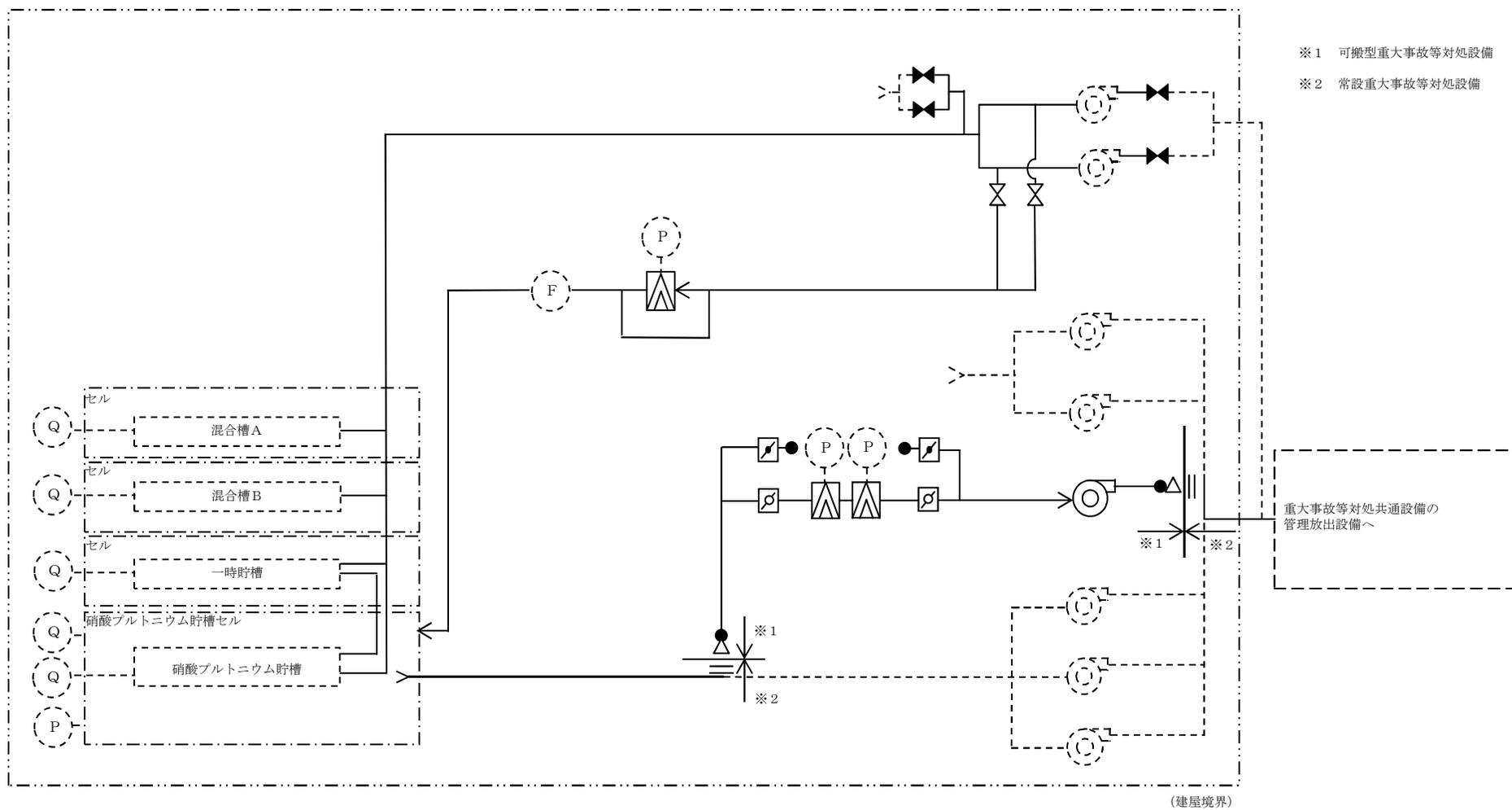
第1.3-30図 ウラン・プルトニウム混合脱硝建屋の放出低減対策の系統概要図
