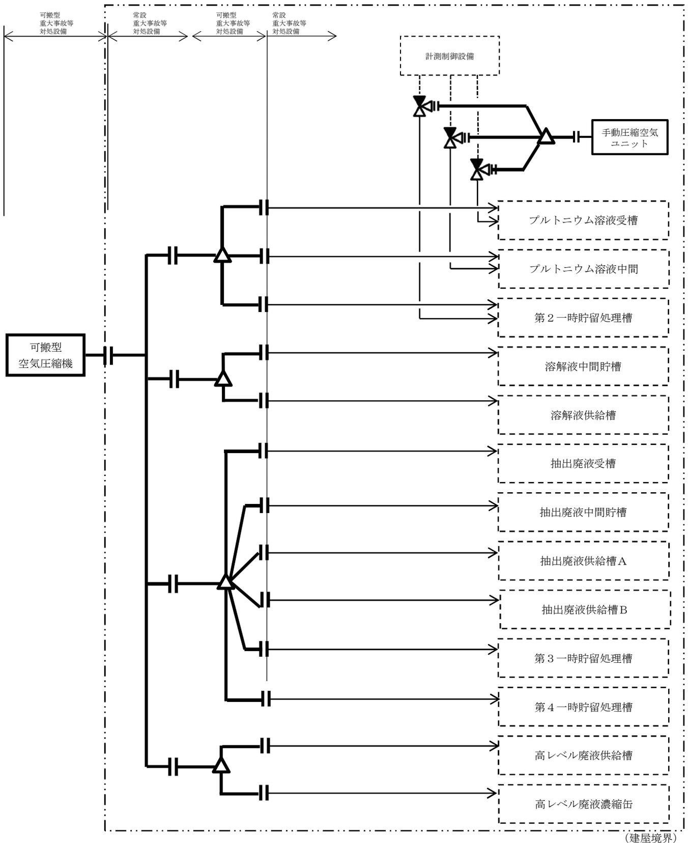
本図は、分離建屋水素爆発の2系統のうち1系統の第1接続口の接続例である。分離建屋水素爆発の他の1系統及び第2接続口に接続した場合も同様の系統である。ただし、接続金具等の個数及び位置は、ホース敷設ルート毎に異なる。
