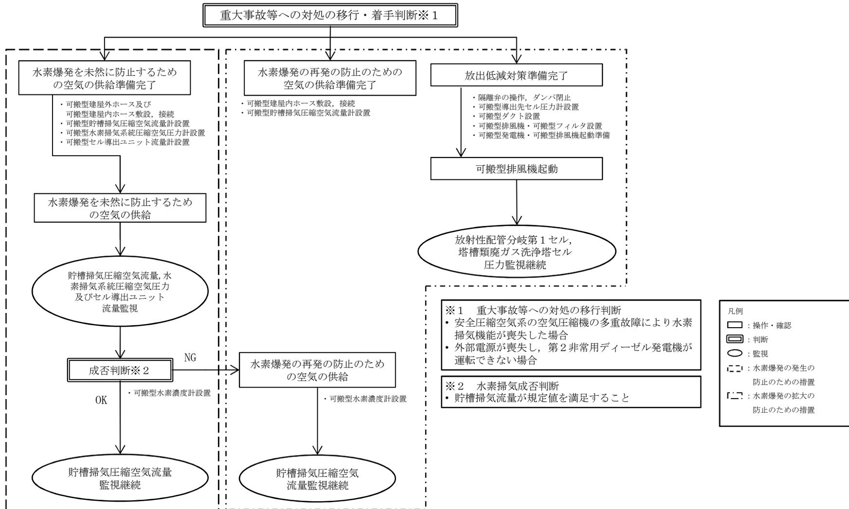
第1.3-4 図 分離建屋の水素爆発の発生及び拡大の防止のための措置の手順の概要
