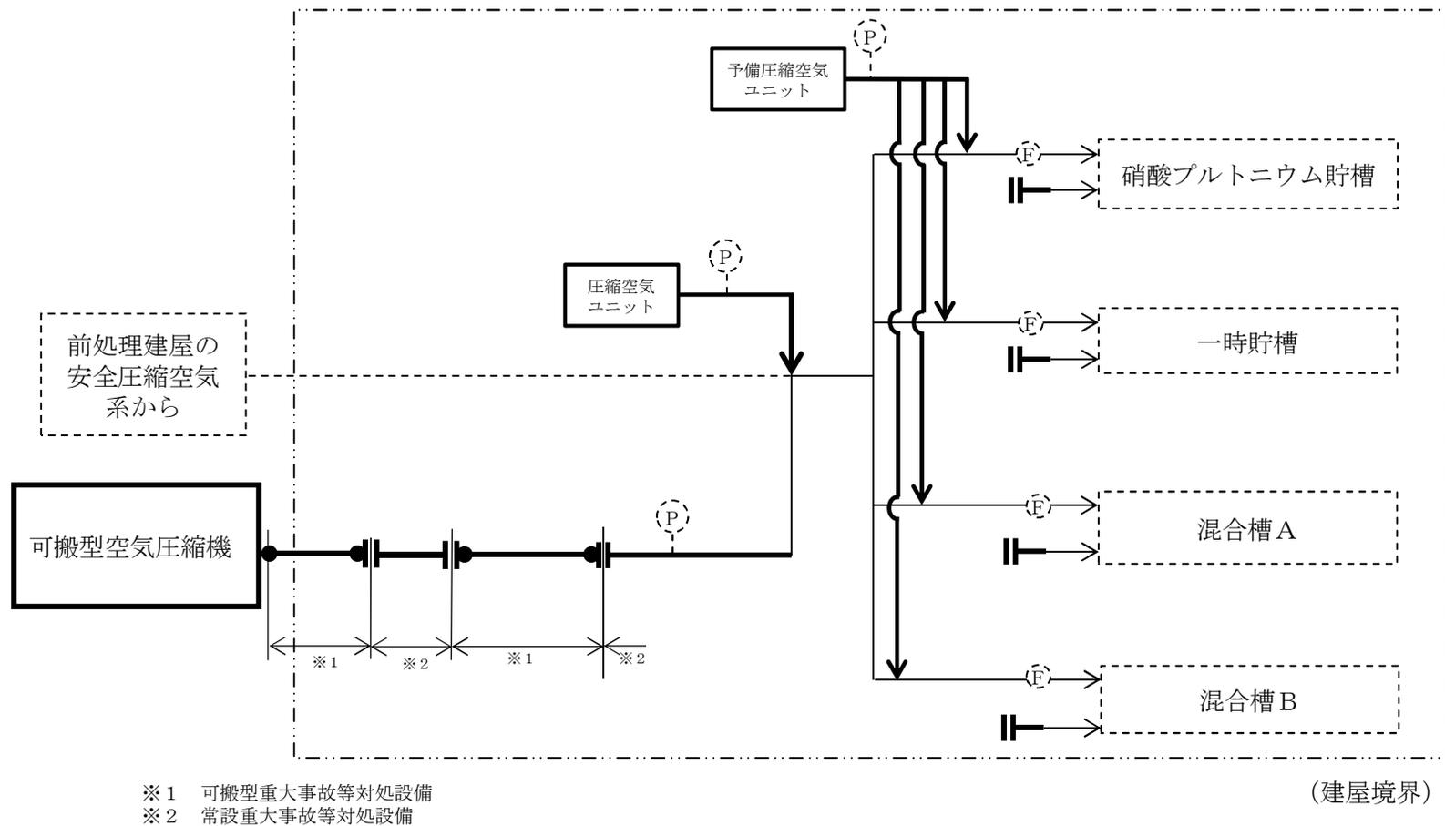
本図は、ウラン・プルトニウム混合脱硝建屋の水素爆発を未然に防止するための空気の供給に使用する設備の2系統の接続口うち、第1接続口の接続例である。第2接続口に接続した場合は系統構成が異なる。なお、接続金具等の個数及び位置は、ホース敷設ルート毎に異なる。
