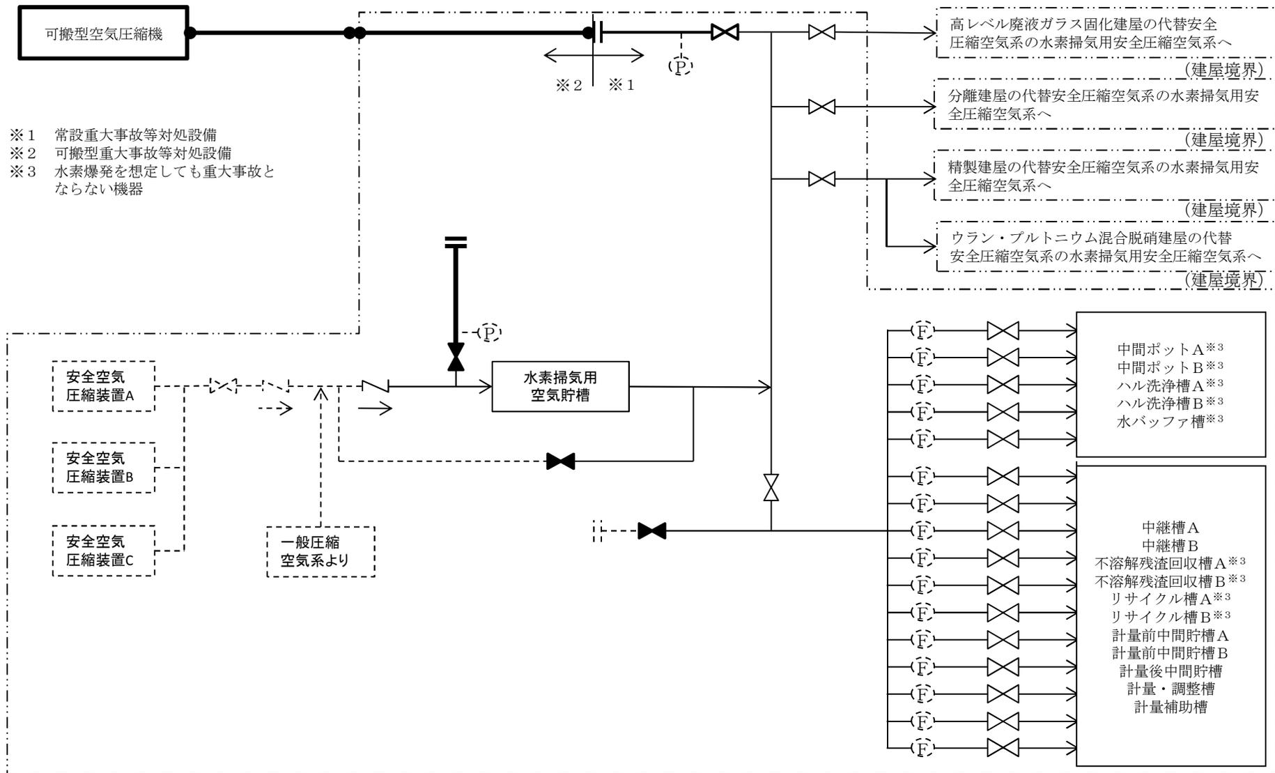
本図は、前処理建屋水素爆発の2系統のうち1系統の第1接続口の接続例である。前処理建屋水素爆発の他の1系統及び第2接続口に接続した場合も同様の系統である。
