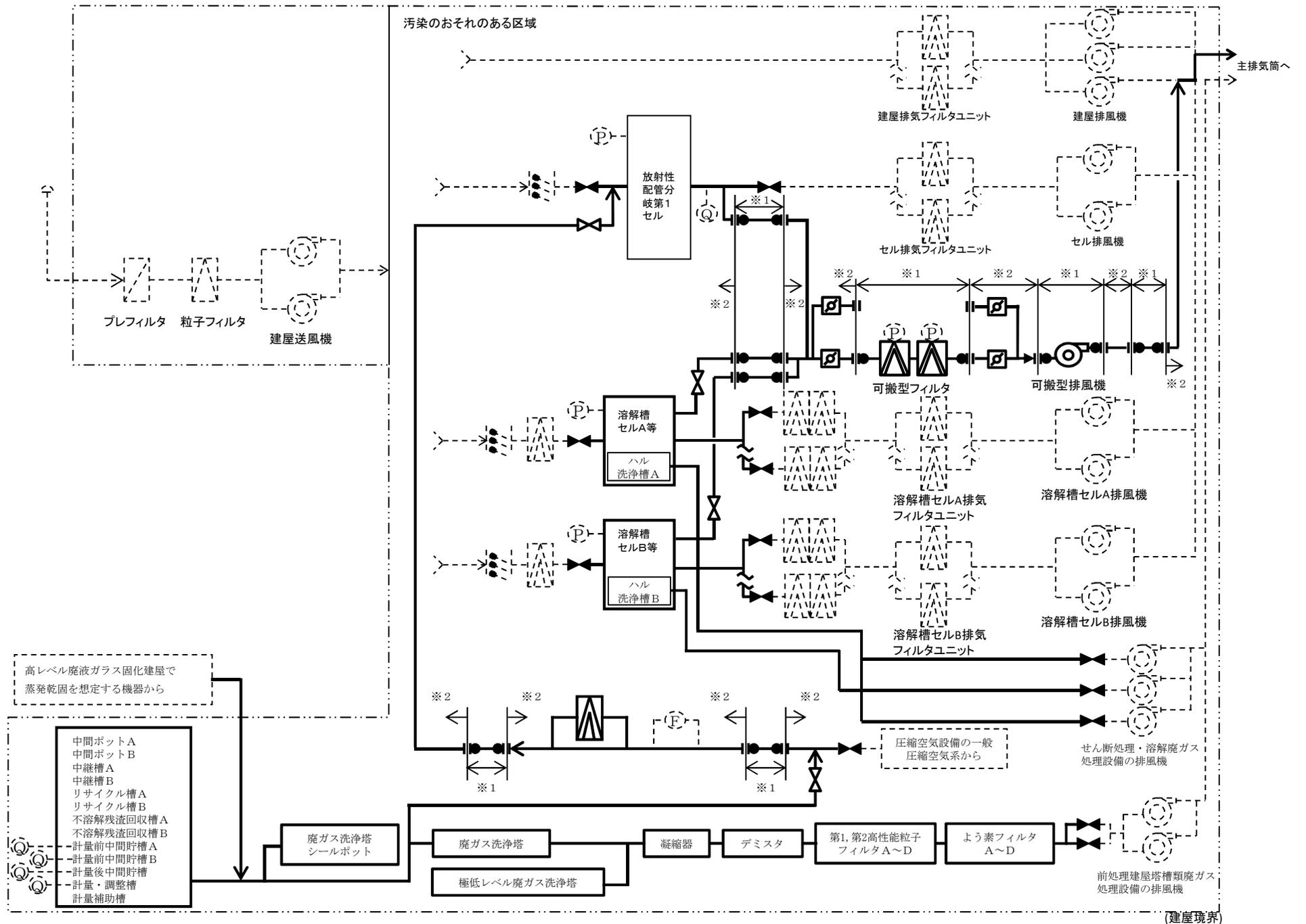
第1.3-27図 前処理建屋の放出低減対策の系統概要図
