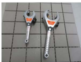
小口径用ラチェット式パイプカッター スリムな形状のため狭隙部でも切断可能である。
