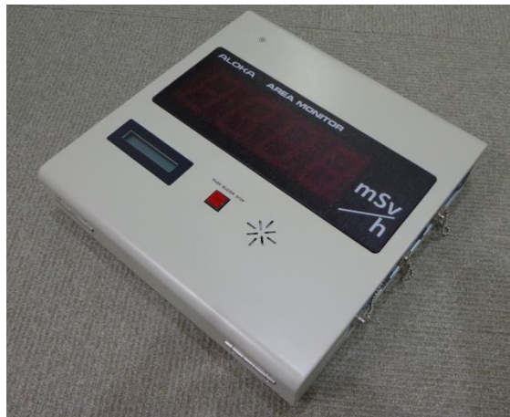
第5図 緊急時対策所エリア モニタ
