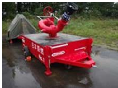
可搬型放水砲
