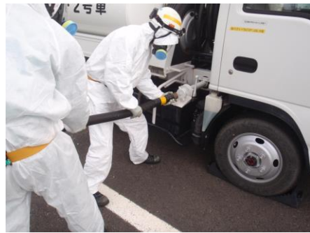
タンクローリへの燃料ホース接続
