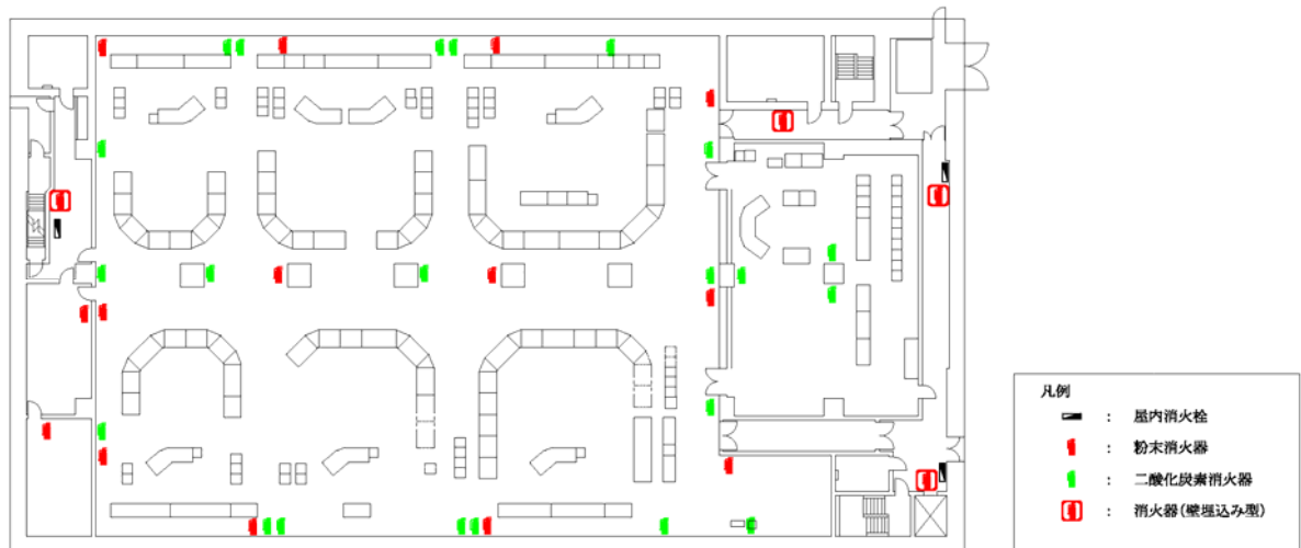
第 12 図 中央制御室の消火設備の設置状況
