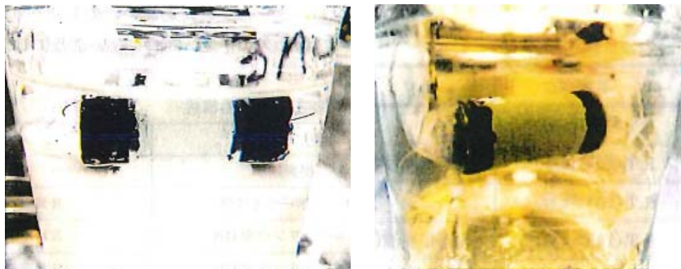
図 2 塗裝配管の浸漬・曝露試験状況
