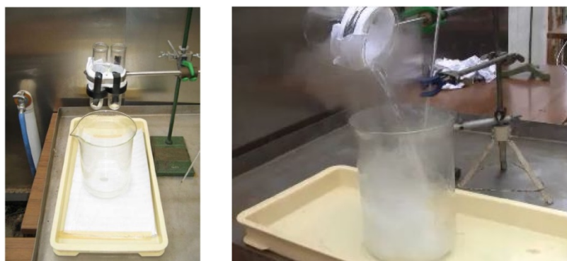
第 2.3-2 図 中量混合試験装置
