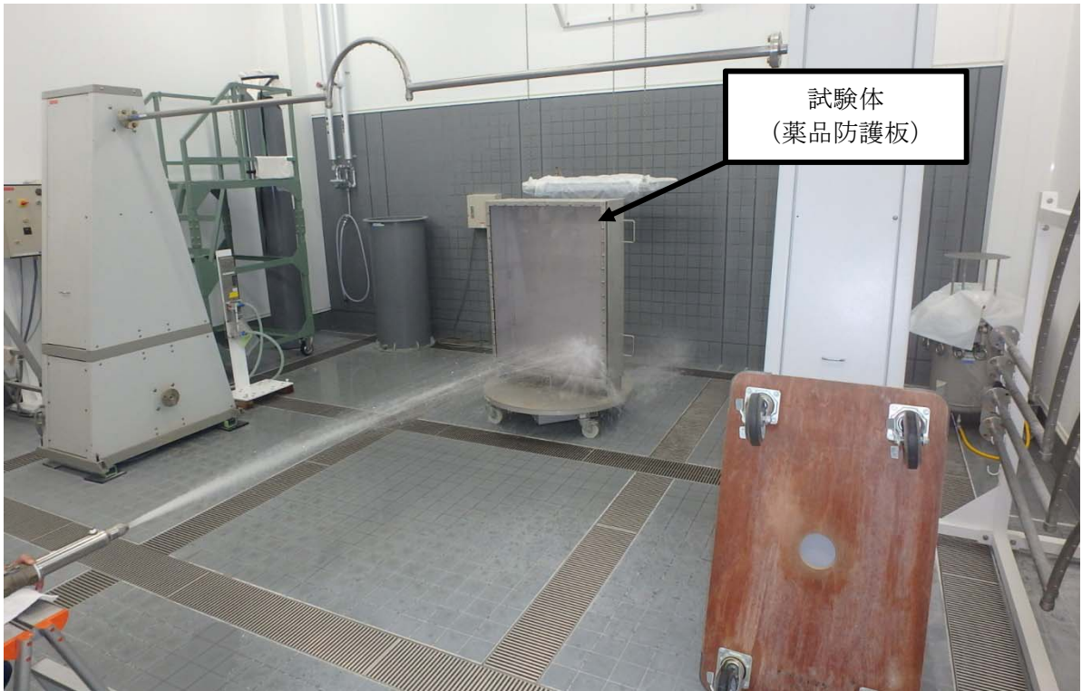
第4図 耐水試験の例（薬品防護板）
